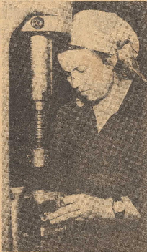
Na zdjęciu: długoletnia pracownica fabryki Anna Długosz przy urządzeniu do montażu złącz wałów napędowych do samochodów ciężarowych.
