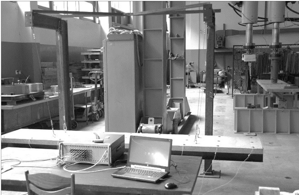
Ryc. 5.68. Belka na stanowisku badawczym do określenia charakterystyk dynamicznych
