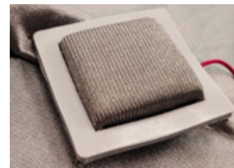
Nowatorska elektroda z materiału przewodzącego zastosowana w kamizelce rejestracyjnej
