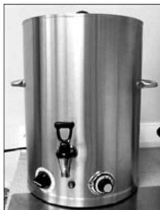
Ryc. 4. Polimeryzowanie materiału we wrzącej wodzie
