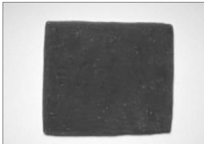
Ryc. 5. Próbkę do badań mikrotwardości, zwilżalności i ścieralności
