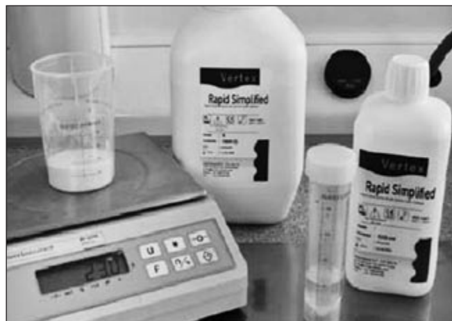
Ryc. 1. Tworzywo Vertex R.S. w postaci proszku i płynu
