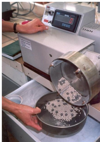
Rys. 8. Urządzenie do badania ścieralności granulek nawozów
