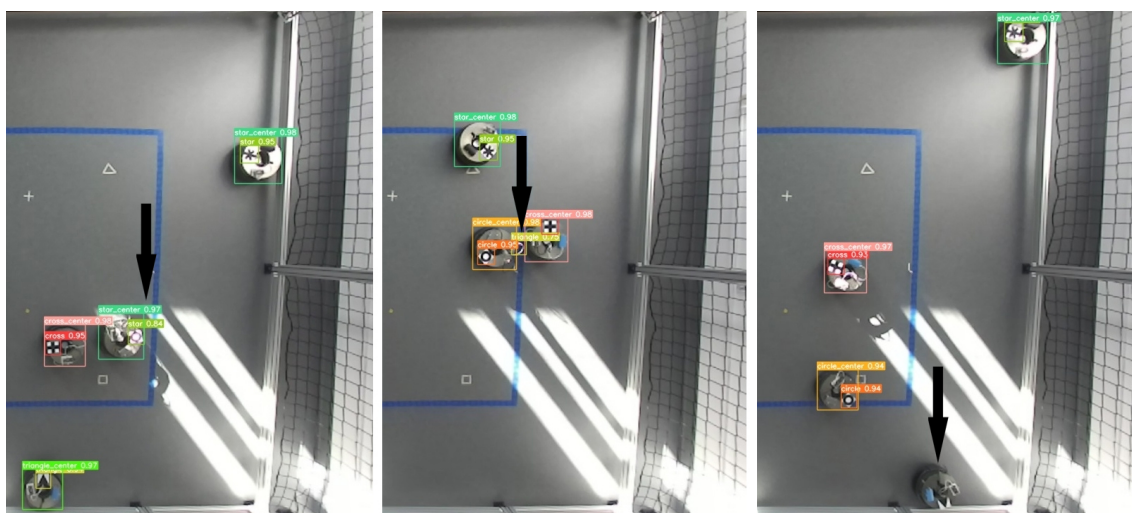
Rysunek 4.15: Przykłady błędnych detekcji modelu YOLO: po lewej – podwójna detekcja robota oznaczonego symbolem gwiazdy, na środku – fałszywie pozytywna detekcja: pętla kabla została rozpoznana jako trójkąt, po prawej fałszywy negatyw – nie rozpoznano trójkąta ani robota nim oznaczonego. (Źródło: opracowanie własne, publikacja [106])
