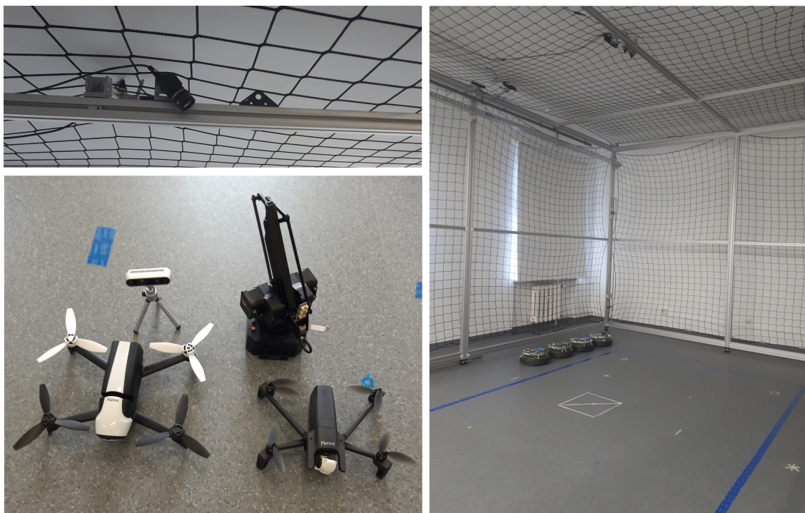
Rysunek 4.1: Wyposażenie Laboratorium Automatyki Mobilnej. Po lewej – u góry kamera zdarzeń, na dole drony oraz ramię robota. Po prawej: widok na klatkę oraz roboty mobilne. (Źródło: opracowanie własne)
