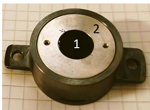
Rys. 13 Pierścień do pomiarów aparatem XPS. 1 – próbka sproszkowanego węgla, 2 –powierzchnia odniesienia pokryta srebrem
