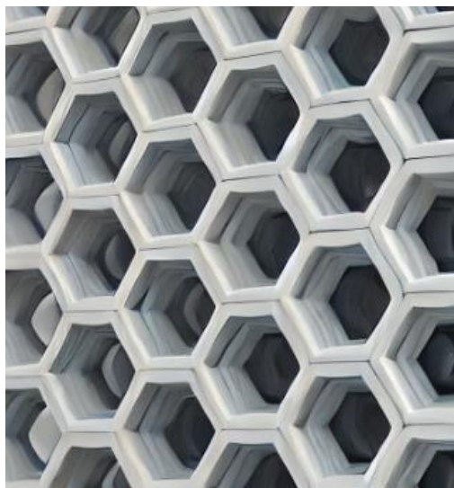
Rys. 44 Struktura teoretycznego materiału węglowego o kanałach w układzie struktury plastra miodu. Ścianki są grubości warstwy grafenu, a zmieniając długość boku sześciokąta może otrzymać kanały o pożądanej średnicy porów
