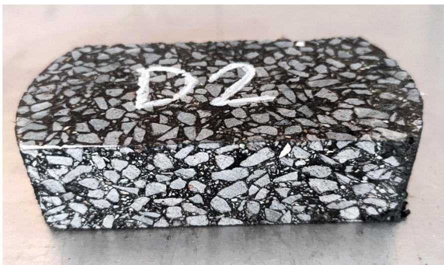
Rys. 3-22. Widok próbki do badania TxOT
