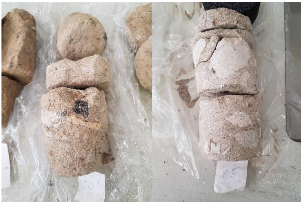
Rys. 5-3. Przykładowe próbki z warstwy stabilizacji C_{3/4} , które uległy rozpadowi podczas wiercenia
