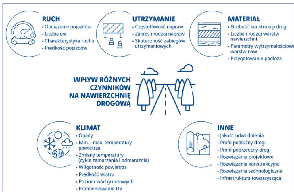
Rys. 2-1. Zestawienie czynników wpływających na trwałość nawierzchni drogowej
