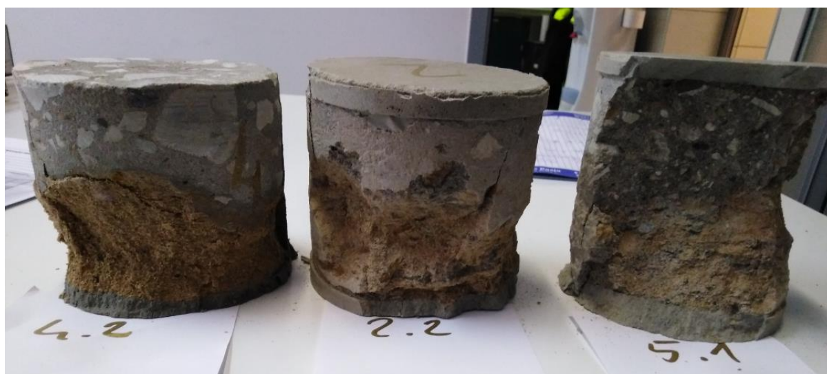
Rys. 5-4. Próbkki z warstwy stabilizacji C_{3/4} o zróżnicowanej strukturze (próbka 2.2 SL – km 2+000, próbka 4.2 SL – km 2+525, próbka 5.1 SP – km 2+800)
