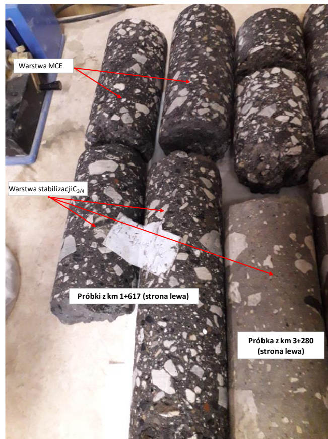
Rys. 5-5. Wygląd próbek z warstwy stabilizacji C_{3/4} i MCE z km 1+617 i km 3+280 (ze strony lewej)
