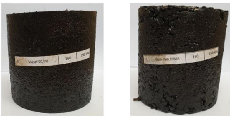
Rys. 3-29. Widok zagęszczonych próbek w prasie żyratorowej a) AC AF 50/70; b) SMA-MA PMB 65/105-80
