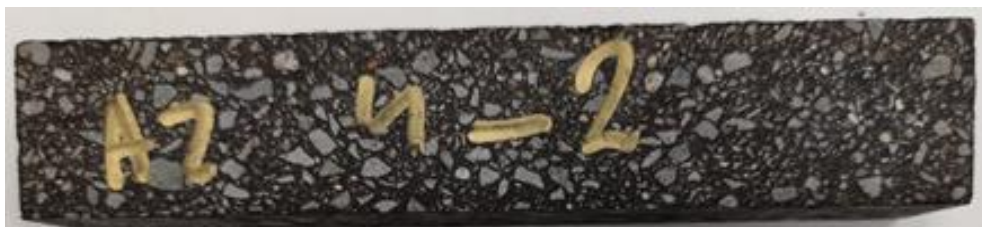
Rys. 3-2. Przekrój przez mieszankę AC AF 50/70
