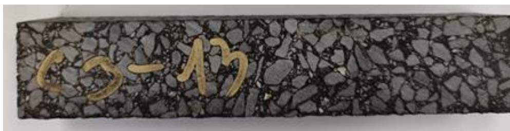
Rys. 3-4. Przekrój przez mieszankę SMA-MA PMB 65/105-80
