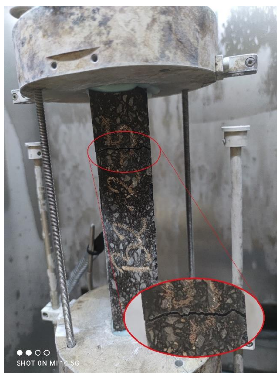
Rys. 3-13. Zniszczenie próbki w badaniu TSRST
