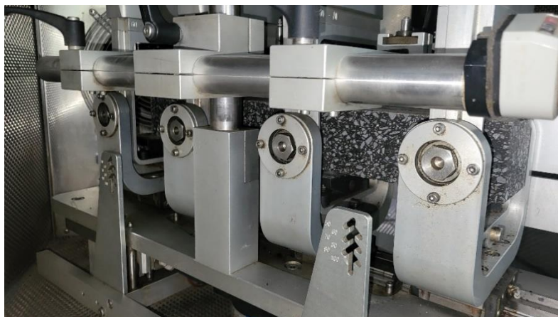
Rys. 3-20. Badanie odporności na zmęczenie 4PB-PR
