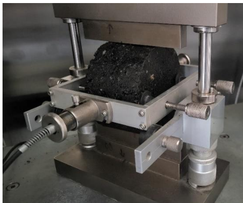
Rys. 3-18. Badanie modułu sztywności IT-CY
