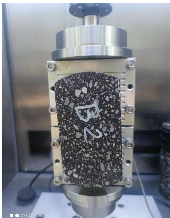
Rys. 3-24. Montaż płyt w maszynie wytrzymałościowej
