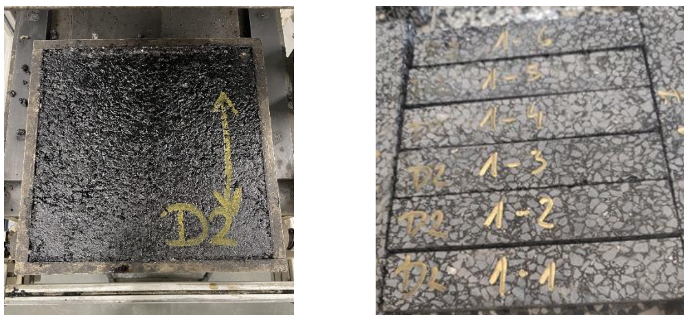
Rys. 3-9. Widok zagęszczonej płyty i podział na próbki analityczne
