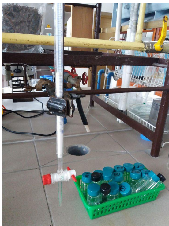
Rysunek 81. Kolumna chromatograficzna do rozdzielenia składników olejku z odpadów kminku.
