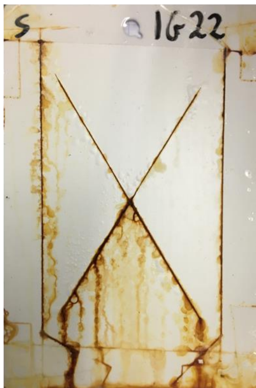
Rysunek 30. Zdjęcia stalowych płyt pokrytych powłokami poliuretanowymi po 1000 h ekspozycji w komorze solnej
