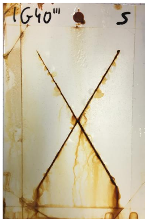
Rysunek 29. Zdjęcia stalowych płyt pokrytych powłokami epoksydowymi po 1000 h ekspozycji w komorze solnej
