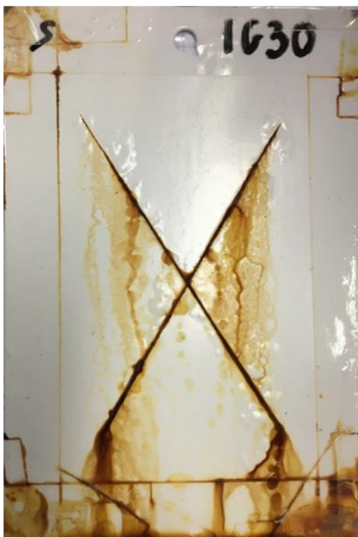
Rysunek 30. Zdjęcia stalowych płyt pokrytych powłokami poliuretanowymi po 1000 h ekspozycji w komorze solnej
