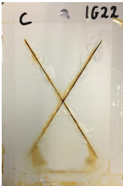
Rysunek 32. Zdjęcia stalowych płyt pokrytych powłokami poliuretanowymi po 1000 h ekspozycji w komorze cyklicznej
