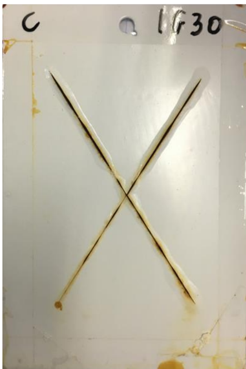
Rysunek 32. Zdjęcia stalowych płyt pokrytych powłokami poliuretanowymi po 1000 h ekspozycji w komorze cyklicznej
