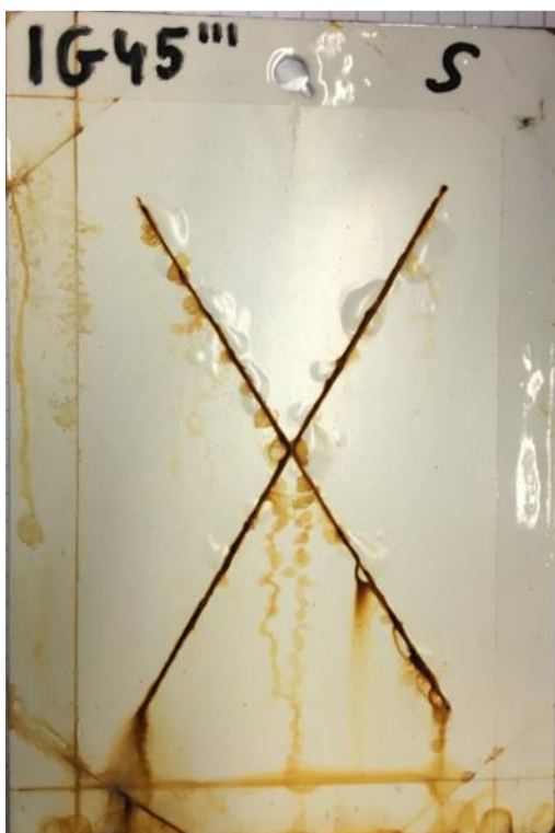
Rysunek 29. Zdjęcia stalowych płyt pokrytych powłokami epoksydowymi po 1000 h ekspozycji w komorze solnej
