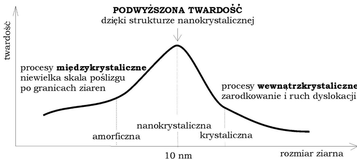
Rysunek 3.1. Schematyczna ilustracja zależności twardości powłoki od rozmiaru ziarna (rodzaju mikrostruktury) [108]
