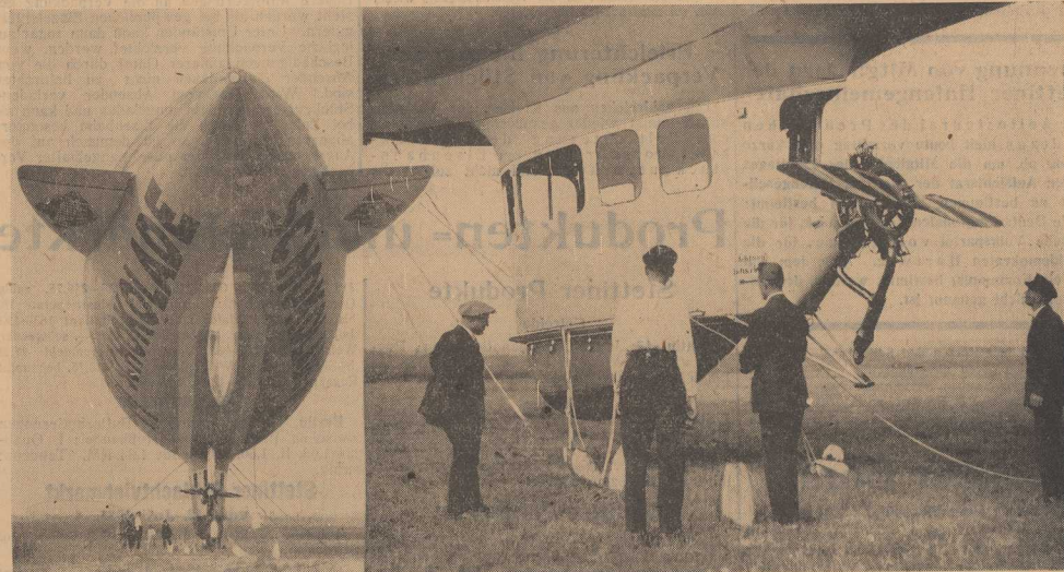
Die Gondel des „D. Pn. 28“ mit dem Motor und dem einzigen Propeller.
