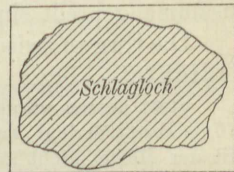
Abb. 117. Ausbesserung eines Schlagloches im Stampfasphaltpflaster.
