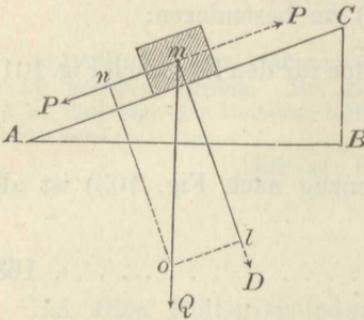
Druck  $D$  an, während  $m n$  die Kraft  $P$  darstellt, welche die Last in der Richtung der schiefen Ebene abwärts zu bewegen sucht. Um die Last auf der schiefen Ebene im Gleichgewicht zu erhalten, muß der erstgenannten Kraft  $P$  eine gleich große Kraft  $P$  entgegenwirken.
