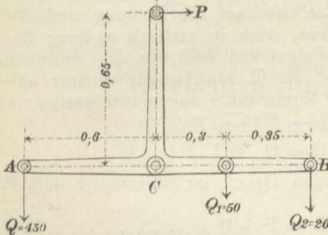
117) Am wagerechten Arme eines Winkelhebels wirken die Lasten
