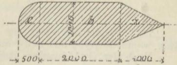
Zerlegt man den Querschnitt des Pfeilers in das Dreieck a, das Rechteck b und den Halbkreis c, so folgt für den Flächeninhalt des Querschnittes — in Dezimetern:
