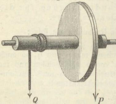
Für die Bestimmung des Gleichgewichtszustandes am Wellrade kommen die Gesetze des zweiarmigen Hebels in Betracht.
