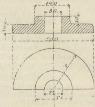
188) Ein Brückenpfeiler aus Ziegelmauerwerk besitzt die in Fig. 127) angegebene Form und ist 6 m hoch. Wie groß ist sein Gewicht, wenn das spezifische Gewicht des Mauerwerks zu 1,8 angenommen wird?
