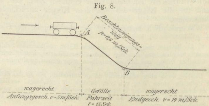
gleichförmig anfahrend, innerhalb eines gewissen Gefälles (Talfahrt) eine bestimmte Beschleunigung aufnimmt, um nach Verlassen des Gefälles auf wagerechter Strecke weiterzufahren. (Fig. 8.)
