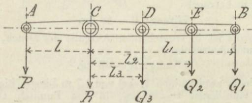
Wirken die an einem Hebel tätigen Kräfte in verschiedenen Schwingungsebenen (Fig. 80), so ändert sich die Momentengleichung
