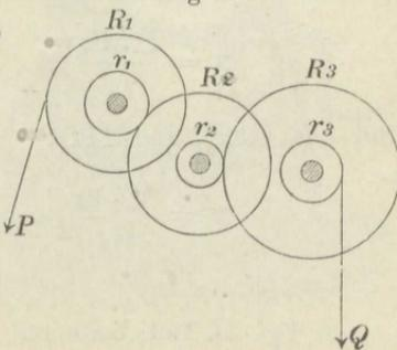
Um die Bedingungen für den Gleichgewichtszustand eines solchen Räderwerkes zu untersuchen, verfährt man auf dieselbe Weise wie bei den zusammengesetzten Hebelwerken.\*)
