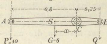
Da der Hebel überall gleich stark ist, so liegt sein Schwerpunkt  $S$  in der Mitte seiner Länge. Bezeichnet man die Entfernung des Schwerpunktes vom Drehpunkte  $C$  mit  $x$  und das Gewicht des Hebels mit  $G$ , so erhält man für den Gleichgewichtszustand, entsprechend Formel 120):
