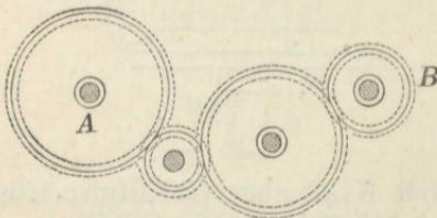
Erfolgt die Bewegung der getriebenen Welle B durch die treibende Welle A mittels sog. Vorgelege-Räder, welche zu je zweien auf einer Zwischenwelle sitzen Fig. 115 und 116) — so findet
