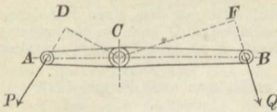
Man nennt den Hebel in Fig. 65) einen zweiarmigen, den in Fig. 66) einen einarmigen Hebel. Wirken die Kräfte nicht in paralleler Richtung (Fig. 67), so ist für den Gleichgewichtszustand:\*)
