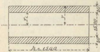
Guldinschen Regel (Seite 199, Beispiel 179), und das andere Mal aus der Differenz der beiden Zylinder von den Halbmessern  $r$  und  $r_1$  (Fig. 125), also:
