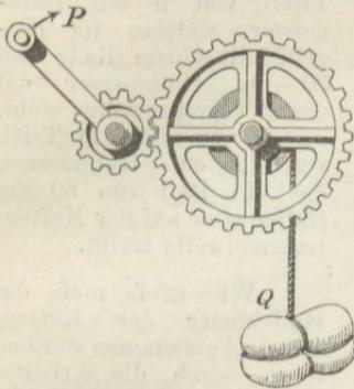
126) An einer Winde, deren Räderwerk in Fig. 92) dargestellt ist, wirken zwei Arbeiter, jeder mit einer Kraft von 10 kg, an einer 40 cm langen Kurbel. Das auf der Kurbelwelle sitzende Trieb hat 6 cm, das Rad auf der Trommelwelle 36 cm und die Seiltrommel 10 cm Halbmesser. Welche Last kann durch diese Kraft im Gleichgewicht gehalten werden?
