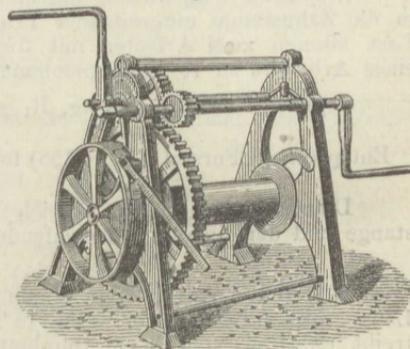
129) Ein Krahn (Fig. 94), hat zwei Vorgelege mit Kurbeln von 45 cm Länge, an denen je ein Arbeiter mit einer Kraft von 12 kg tätig ist. Auf
