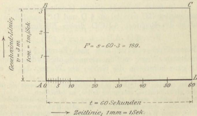
Berücksichtigung des zu Fig. 1) Gesagten, die Zeitlinie  $AD = 60 \text{ mm}$ , ferner die Geschwindigkeitslinie  $AB = 3 \text{ cm}$  und vervollständige zum Rechteck, dann ist dessen
