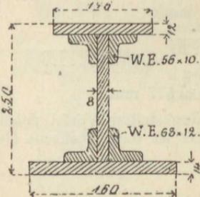
145) Wieviel kg wiegt ein schmiedeeiserner Träger nach Fig. 130), wenn derselbe 6 m lang ist und wenn von den Abmessungen des Profils abgesehen wird? ( $s = 7,8$ .)
