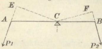
$$P_1 \cdot EC = P_2 \cdot FC \quad \dots \dots \dots 121)$$
