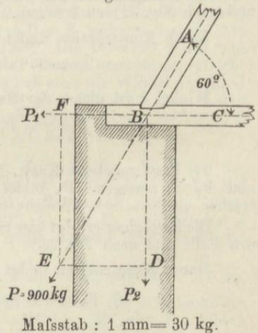
98) An der Hängesäule eines einfachen Sprengwerkes (Fig. 51), wirkt in senkrechter Richtung ein Zug  $P = 3000 \text{ kg}$ ; die Streben sind unter einem Winkel von  $36^\circ$  gegen eine wagerechte Gerade geneigt. Welchen Druck erhält jede Strebe?
