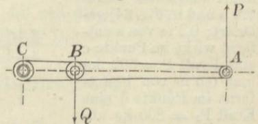
$$P \cdot AC = Q \cdot BC \dots\dots\dots 122)$$
