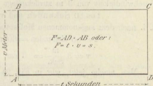
selben die in jeder Sekunde gleiche Geschwindigkeit  $v$ , und zieht man weiter  $BC$  parallel zu  $AD$  und  $DC$  parallel zu  $AB$ , so entsteht das Rechteck  $ABCD$ , dessen Flächeninhalt
