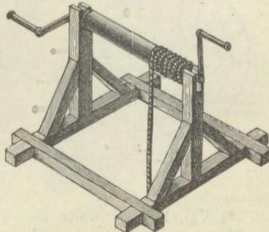
Wirken an einem solchen Kurbelhaspel zwei Arbeiter zusammen mit einer Kraft  $P = 16$  kg an einer Kurbel von 40 cm Länge und einem Wellen-Halbmesser von 12 cm, so erhält man nach Formel 144) als zu hebende Last:
