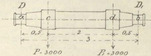
Wird b als Drehpunkt angenommen und bezeichnet man den Druck in D mit x und den in D<sub>1</sub> mit y, so erhält man für den Gleichgewichtszustand:
