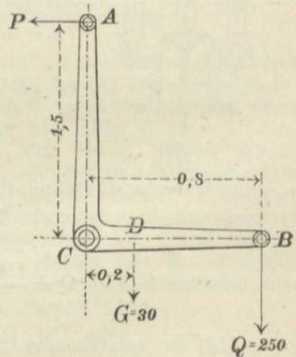
116) An einem Winkelhebel wirkt senkrecht abwärts eine Last  $Q = 250 \text{ kg}$  an einem Hebelarme  $BC = 0,8 \text{ m}$ . (Fig. 74.)
