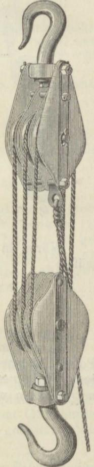
Ist dieses Seil an der festen Flasche befestigt, wie Fig. 100) zeigt, so ist stets die gleiche Anzahl Rollen in jeder Flasche erforderlich; ist es aber an der losen, beweglichen Flasche fest gemacht, wie in Fig. 101), so muß in der festen Flasche stets eine Rolle mehr vorhanden sein.
