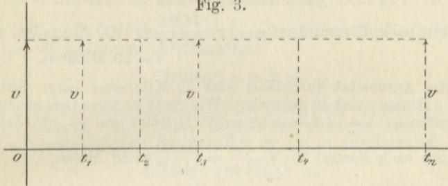
Trägt man auf einer wagerechten Geraden, von o ausgehend, Längen  $ot_1, ot_2, ot_3 \dots ot_n$  auf, die den Zeiten  $t_1, t_2, t_3 \dots t_n$  gleich sind, und senkrecht dazu in den einzelnen Teilpunkten die immer gleichbleibende Geschwindigkeit  $v$ , so stellen die Rechtecke über den Zeitlinien  $ot_1, ot_2, ot_3 \dots ot_n$  die entsprechenden Größen der zurückgelegten Wege dar.
