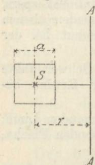
175) Oberfläche eines Ringes mit quadratischem Querschnitt.
