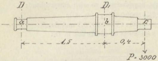
82) Eine Achse ist in den Punkten a und b, welche 1,5 m voneinander entfernt sind (Fig. 62), gelagert. Im Punkte c ist die Achse mit P = 3000 kg belastet; wie groß sind die Drucke in den Lagermitten D und D<sub>1</sub>, wenn b c = 0,4 m ist?
