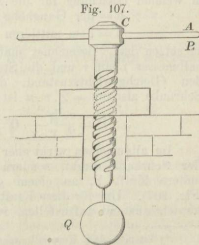
Jeder einzelne Schraubengang ist als eine schiefe Ebene aufzufassen, deren Basis gleich dem Umfange der Schraubenspindel, und deren Höhe gleich der Steigung eines Schraubenganges ist.
