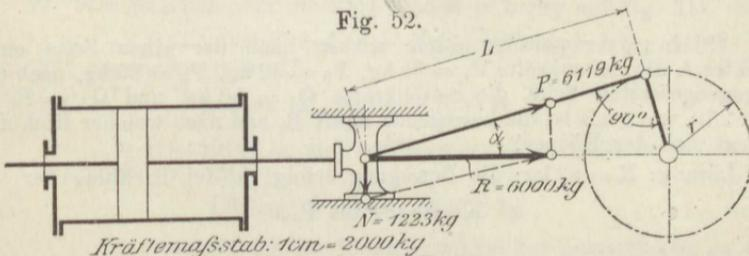
Führt man die Zerlegung der Kraft  $R$  maßstäblich\*\* ) und wie in Fig. 52) angegeben aus, so findet man:
