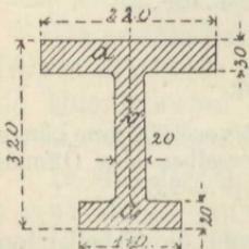
187) Wie groß ist das Gewicht eines gußeisernen Trägers nach Fig. 126), wenn derselbe 5 m lang ist? ( $s = 7,3$ .)
