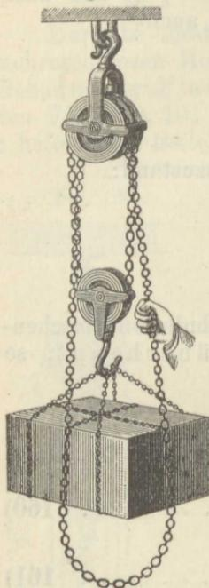
Der Differential-Flaschenzug besteht aus zwei in einem Stück gegossenen festen Rollen, deren Durchmesser nur wenig von einander verschieden sind, und aus einer losen Rolle, an welcher die Last angreift. (Fig. 103.)
