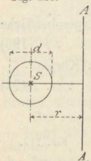
176) Oberfläche eines Ringes mit kreisförmigem Querschnitt.
