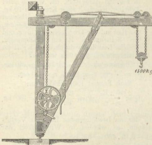
der Kurbelwelle sitzt ein Trieb von 9 cm Halbmesser, welches im Eingriff mit einem Rade von 30 cm Halbmesser auf der Vorgelegewelle steht. Auf dieser sitzt ein Trieb von 12 cm Halbmesser, das ein Rad von 60 cm Halbmesser auf der Kettentrommelwelle treibt.
