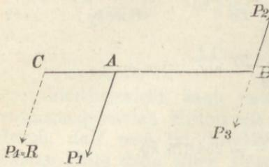
Seitenkräfte  $P_3$  und  $P_4$  derart, dass  $P_3 = P_2$  und entsprechend  $P_4 = P_1 - P_2$  wird.
