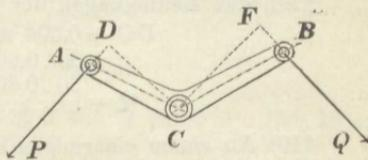
Sind die Richtungslinien der am Winkelhebel tätigen Kräfte nicht parallel (Fig. 69), so ist auch hier für den Gleichgewichtszustand:\*)
