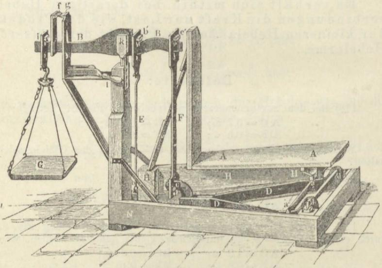
Die Dezimalwaage, nach ihrem Erfinder die „Quintenzsche oder auch wohl die Strafsburger Brückenwaage“ genannt, ist eine der gebräuchlichsten Wagen, welche überall da Verwendung findet, wo die zu wiegenden Lasten einen größeren Rauminhalt besitzen. Fig. 84) stellt diese Waage in der Ansicht dar.
