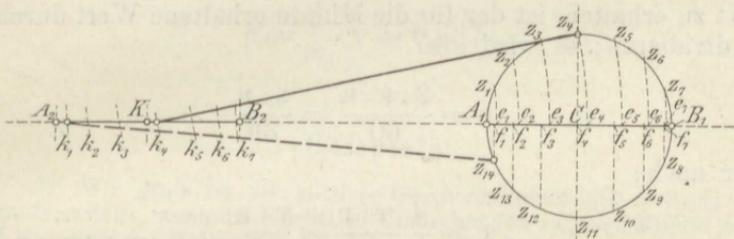
Unter Annahme einer unendlich langen Pleuellinie würden an Stelle der Kreisbögen  $z_1 e_1, z_2 e_2, z_3 e_3, \dots$  die senkrechten, geraden Linien  $z_{14} f_1, z_{13} f_2, z_{12} f_3, \dots$  treten. In diesem Falle sind dann die Kolbenwege rechts und links von der Pleuellinie einander gleich, d. h. es ist
