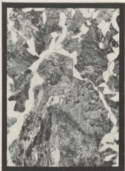
Abb. 40. Stahlguß mit 0,45% C. Gußzustand ; hell = Ferrit, getönt = Perlit.
