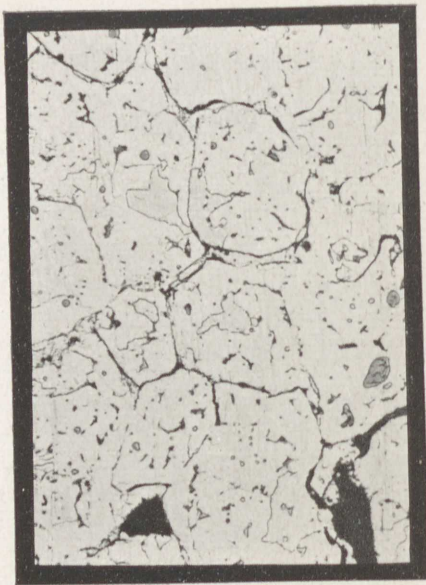
Abb. 44. Weiches Flußeisen, verbrannt. Es bilden sich längs der Korngrenzen dunkle oxydische Einschlüsse.
