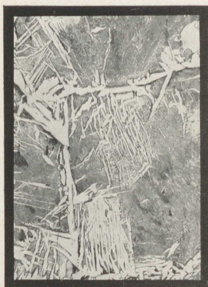
Abb. 43. Stahl mit 0,4% C. Typisches Überhitzungsgefüge. Hell = Ferrit, in Nadelform, dunkel = Perlit.
