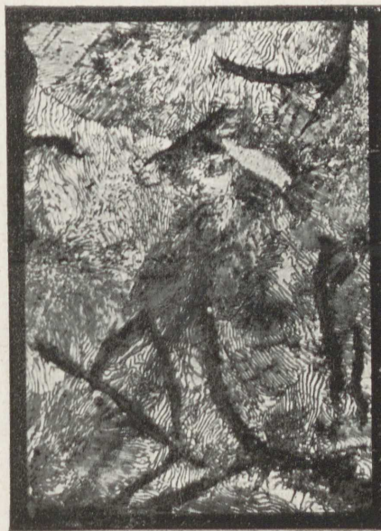
Abb. 49. Vergrößerung 250fach. Weicher Maschinenfluß mit 3,35% C, 2,10% Si, 0,67% Mn. Schwarze Graphitadern, umgeben von hellem Ferrit. Dunkle Flächen = Perlit, in diesem Phosphiteutektikum.
