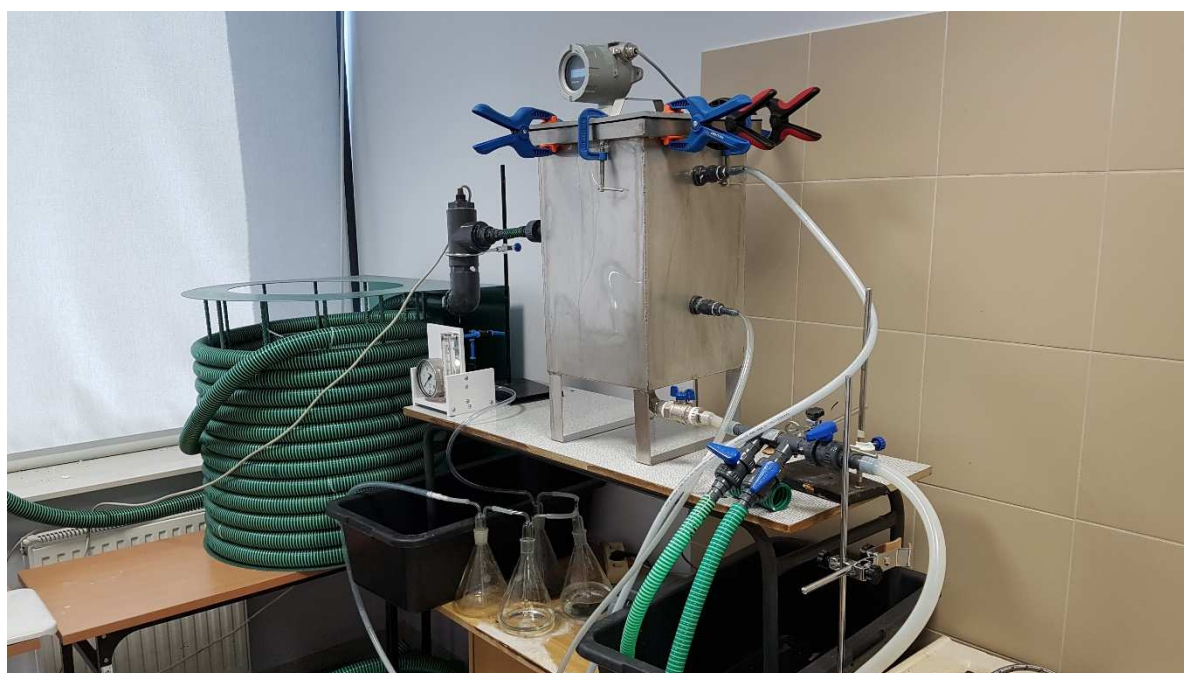
Rys. 13 Fragment stanowiska badawczego – rurociąg tłoczny, zbiornik B
