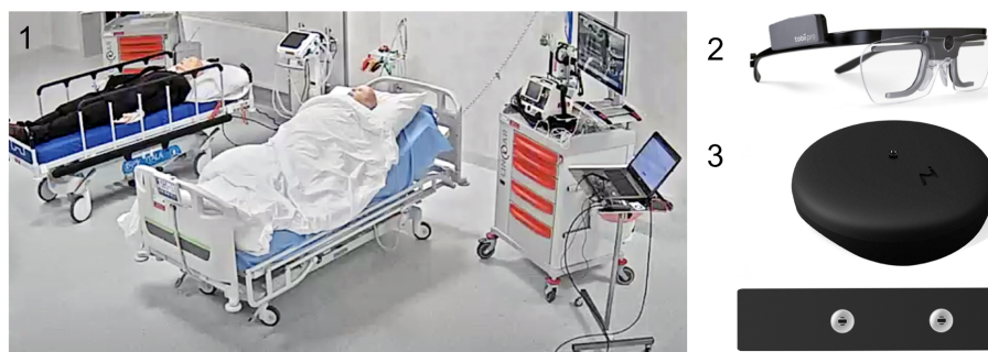
Rysunek 5.24. Stanowisko badawcze (1) złożone z łóżka, na którym leży fantom (pacjent), kardiomonitora, (2) okulografu (ET) Tobii Eye Tracker 2 [41] z laptopem rejestrującym dane oraz (3) pasa piersiowego do zapisu sygnału EKG (AidLab) [16]. Stanowisko zlokalizowane jest w Centrum Symulacji Medycznej Collegium Medicum Uniwersytetu Zielonogórskiego. Źródło: [20].
