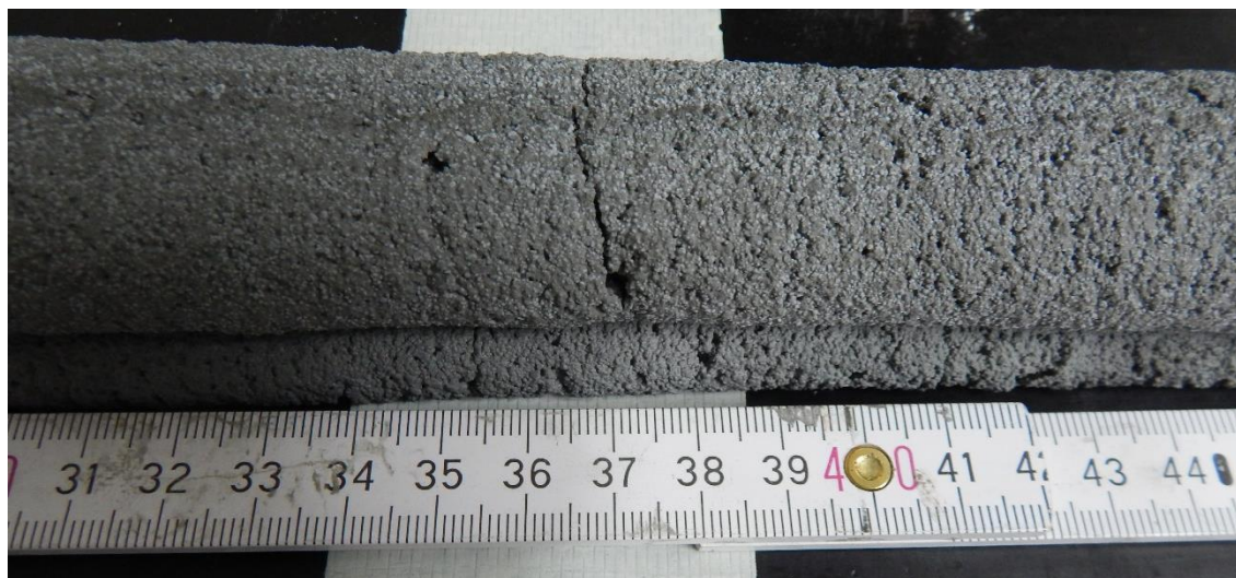
Rysunek 171. Zarysowanie próbki w trakcie badania skurczu ograniczonego.
