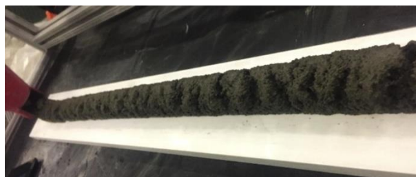
Rysunek 15. Przykład braku ciągłości mieszanki ze względu na zbyt dużą sztywność, Kazemian A. i inni, 2017 [63].
