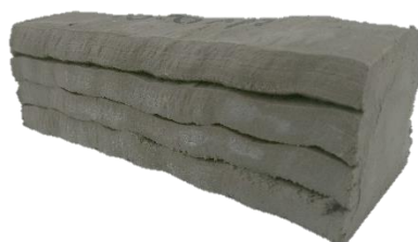
Rysunek 62 Wielowarstwowa próbka drukowana do badań wytrzymałościowych: a) przed docięciem, b) po docięciu do wymiaru 40 x 40 x 160 mm.
