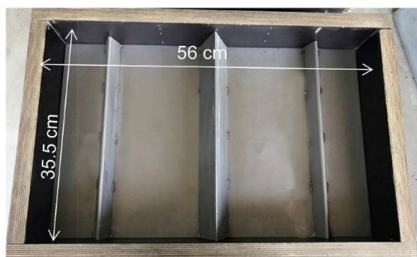
Rysunek 40. Forma do badania skurczu powierzchniowego [235].
