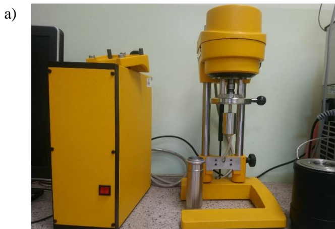
Rysunek 58. Badanie reometryczne zaczynów: a) reometr RN.4.1, b) końcówka stożkowa S1.
