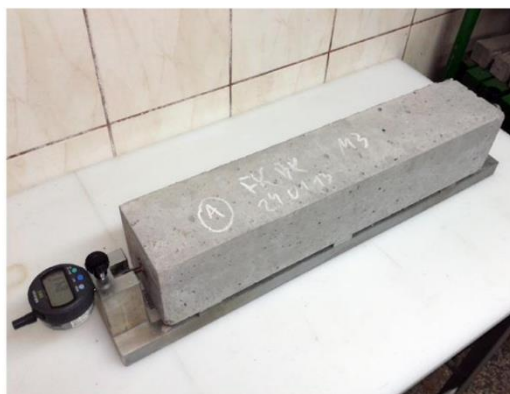
Rysunek 35. Badanie skurczu metodą Amslera: (a) schemat stanowiska pomiarowego; (b) próbka w trakcie badań [215].
