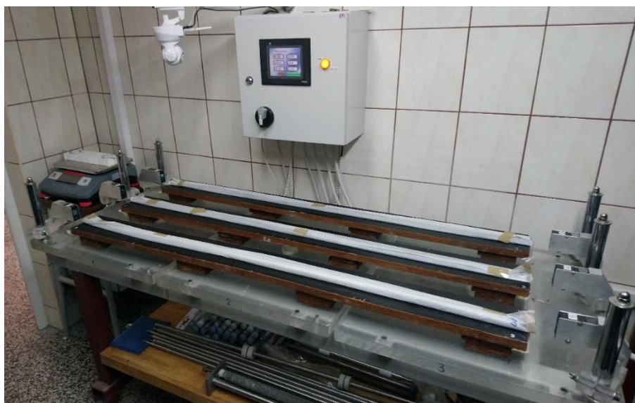
Rysunek 54. Stanowisko badawcze do pomiaru odkształceń elementów drukowanych w 3D [291].
