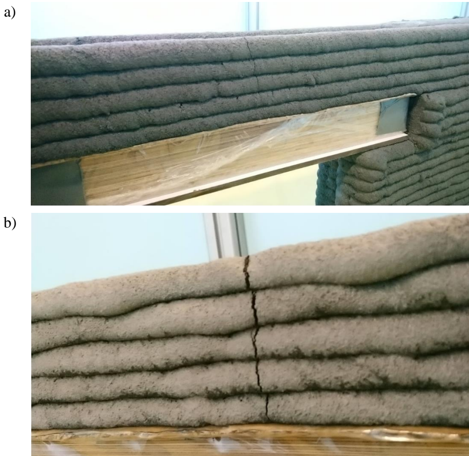
Rysunek 181. Zarysowanie elementów ściennych: a) bez pielęgnacji, b) połączenie pielęgnacji zewnętrznej i wewnętrznej.
