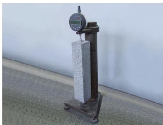
Rysunek 36. Badanie skurczu metodą Graf-Kaufmana: (a) schemat stanowiska pomiarowego; (b) próbka w trakcie badań [215].
