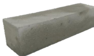
Rysunek 62 Wielowarstwowa próbka drukowana do badań wytrzymałościowych: a) przed docięciem, b) po docięciu do wymiaru 40 x 40 x 160 mm.
