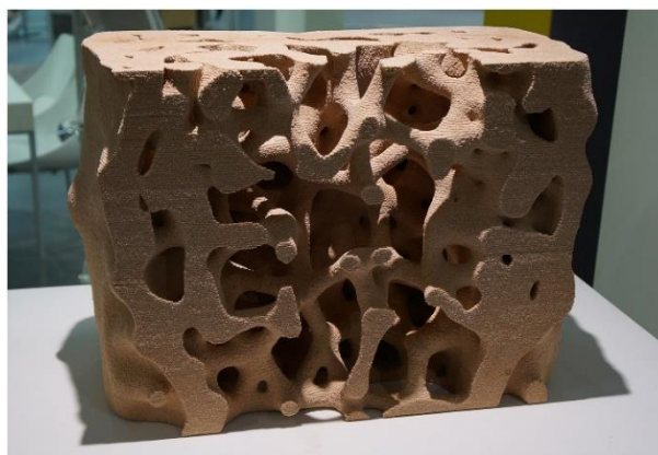
Rysunek 6. Fragment kolumny o zoptymalizowanym kształcie wydrukowany techniką D-shape [25].
