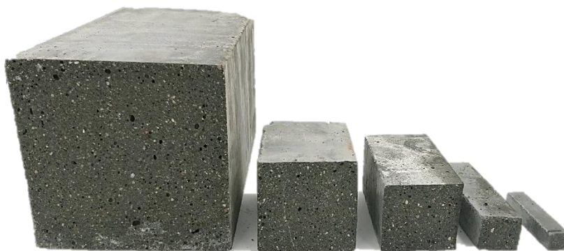
Rysunek 121. Zniszczone próbki w badaniu efektu skali kompozytu cementowego.
