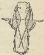
Fig. 47. Verstärkung verfaulten Holz- mastenfüße durch Rundeisen und Beton. Patent der Pittsburgh Reinforcing Pole Co.
