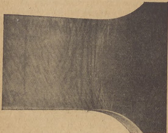
Fig. 14 a. Fließfiguren auf einem Flachstabe.
