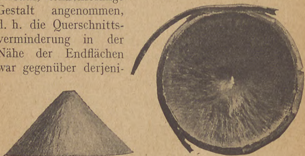
Fig. 36. Brucherscheinung beim Schlagversuch.
