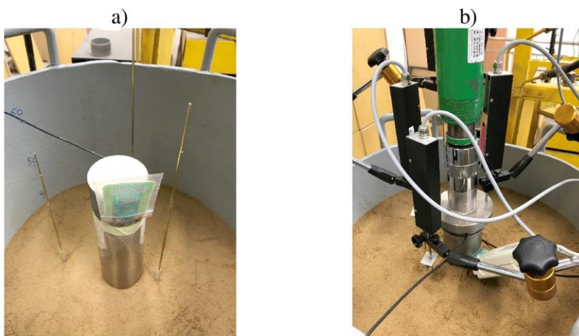
Rys. 29. Stanowisko badawcze do pomiaru składowej poziomej naprężenia w gruncie: a) oprzyrządowany palec; b) widok na głowicę pala
