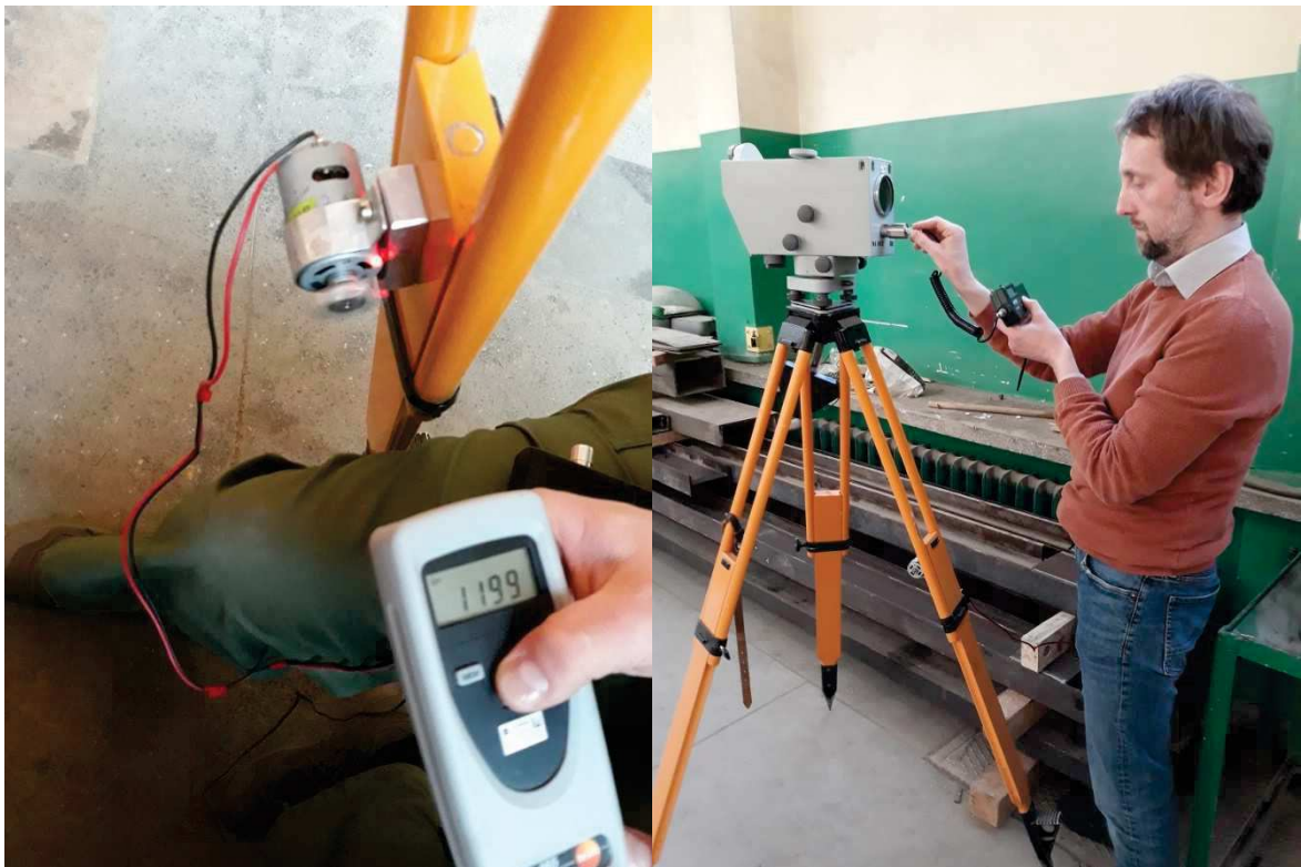
Ryc. 5.15. Pomiar częstotliwości tachometrem Testo 465 i wychyleń niwelatora w jednej z osi wibrometrem Extech VB450 (fotografia własna)
