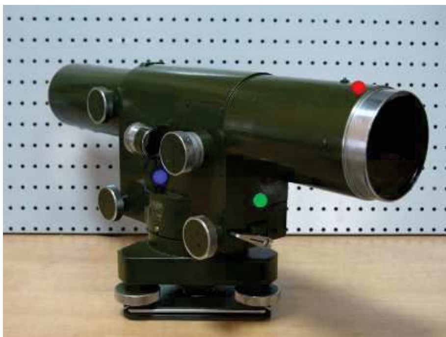
Ryc. 5.16. Punkty pomiaru wychyleń niwelatora Ni 002 ze stanu równowagi w trzech osiach
