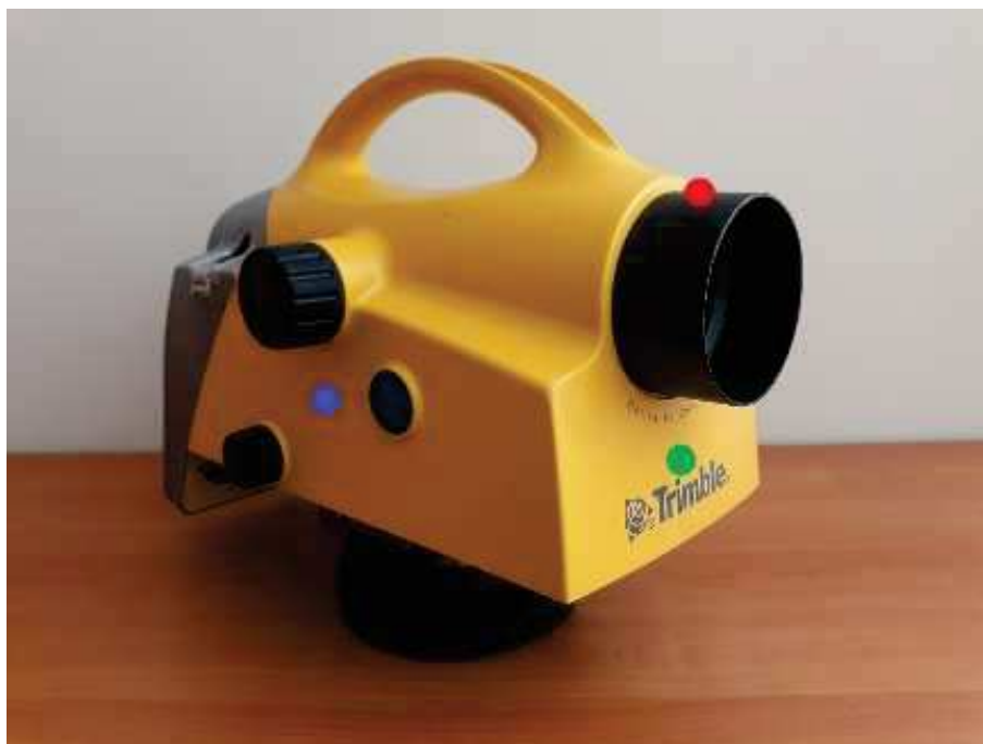
Ryc. 5.18. Punkty pomiaru wychyleń niwelatora DiNi 03 ze stanu równowagi w trzech osiach
