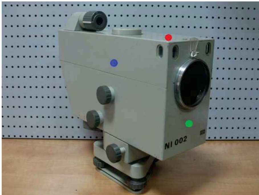
Ryc. 5.16. Punkty pomiaru wychyleń niwelatora Ni 002 ze stanu równowagi w trzech osiach
