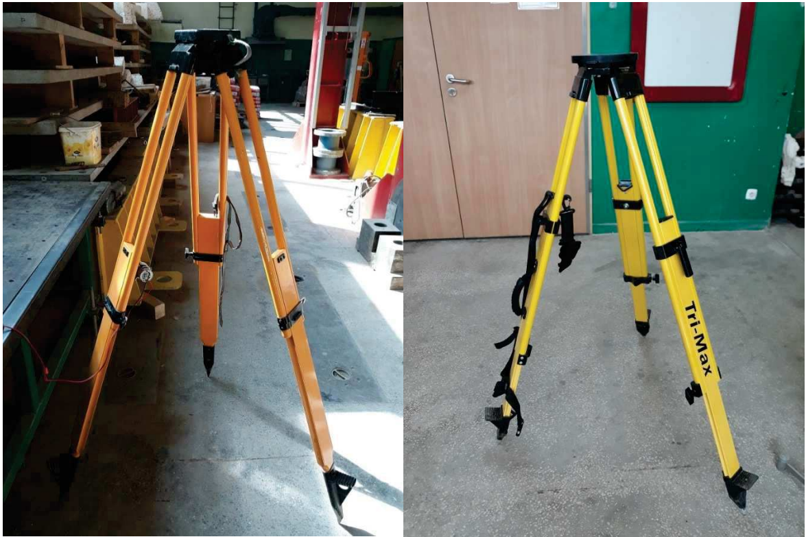
Ryc. 5.13. Statywy wykorzystane podczas badań. Od lewej: Zeiss, Seco (fotografia własna)
