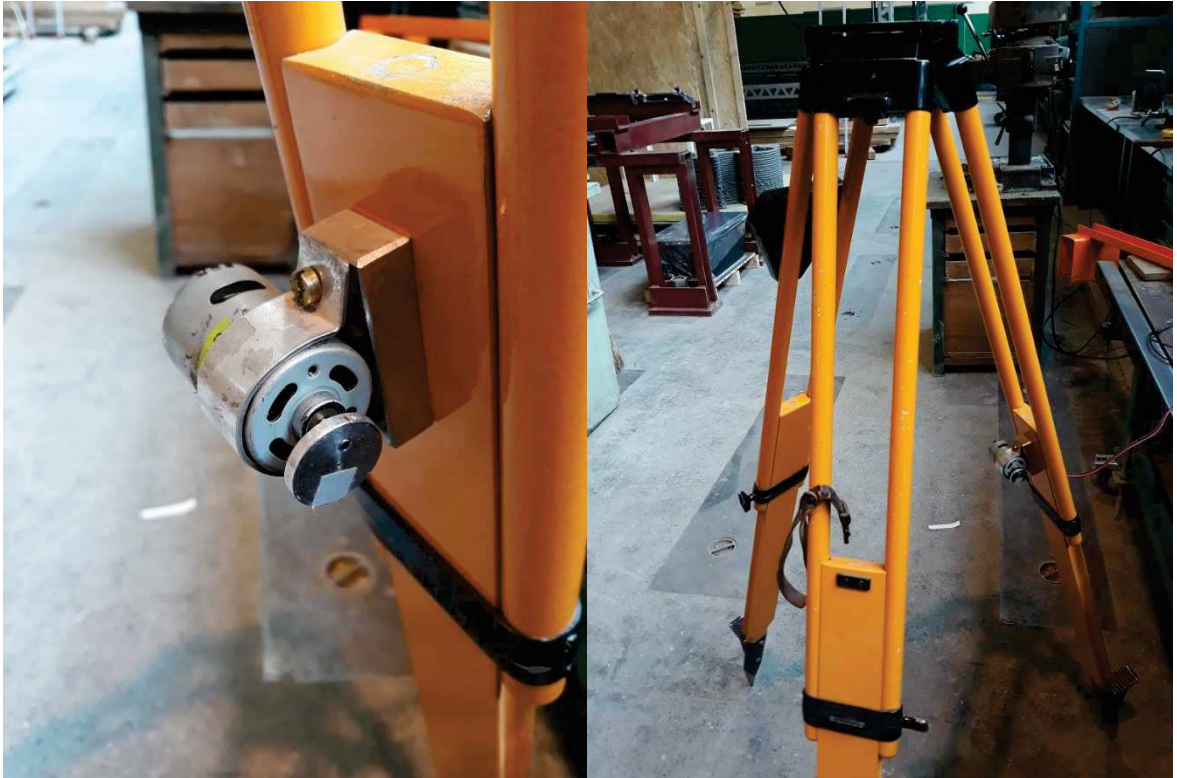
Ryc. 4.7. Statyw instrumentu z silnikiem wymuszającym drgania (fotografia własna)
