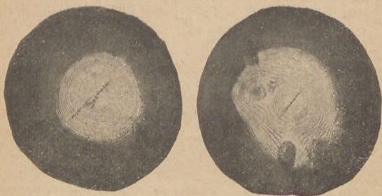
Fig. 15. Kiefer mit Teeröl imprägniert nach dem Rüpingverfahren. (Aus Seidenschnur, Die Bedeutung der Holzkonservierungsfrage beim Bau von Überlandzentralen.)
