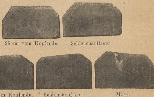
Fig. 13. Fünf Abschnitte ein und derselben buchenen, mit Teeröl getränkten Schwelle. (Aus Glasers Annalen 1910.)
