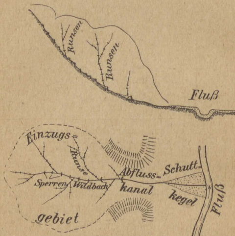
Abb. 78. Schematische Darstellung der Hauptteile eines Wildbaches.
