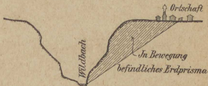
Abb. 80. Folgen der Hangunterwühlung durch einen Wildbach.
