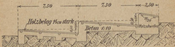
Abb. 75. Sohlenschwelle in der Iller bei Egelsee. Querschnitt.
