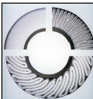
Rys. 3. Metody plisowania membran (KUJAWSKI I WACZYŃSKI, 2008)
