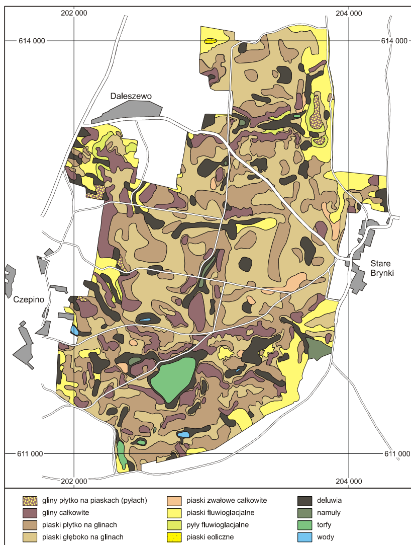
Rys. 60. Przestrzenna zmienność miąższości spiaszczenia skał macierzystych gleb wywołana procesami denudacyjnymi w holocenie przy założeniu, że pierwotnie była dość wyrównana
