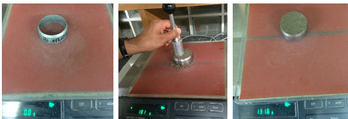
Rys. 6.6 Próbkę gruntu w pierścieniu edometru
