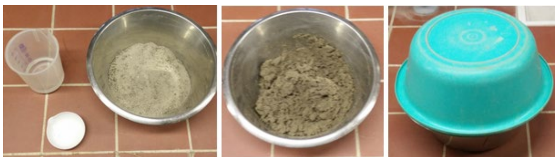
Rys. 6.9 Przygotowanie próbek do badań wytrzymałości na ścinanie
