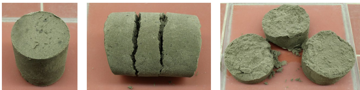
Rys. 6.4 Próbkę po zagęszczeniu po wyjęciu z cylindra Proctora
