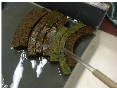
Rys. 6.7 Wilgotne gąbki (np. H 2 O) jako środek zapobiegający wysychaniu badanej próbki
