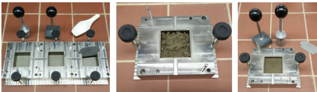
Rys. 6.10 pojemnik aparatu bezpośredniego ścinania z próbką
