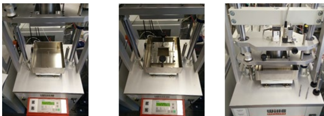
Rys. 6.11 Aparaty bezpośredniego ścinania (od lewej do prawej; bez pojemnika; z pojemnikiem; w czasie trwającej próby ścinania)
