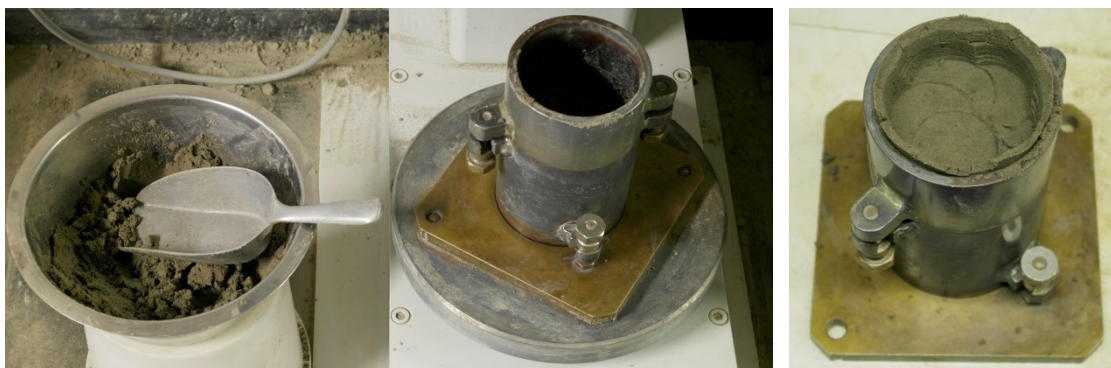
Rys. 6.3 Urządzenie Proctora z cylindrem testowym
