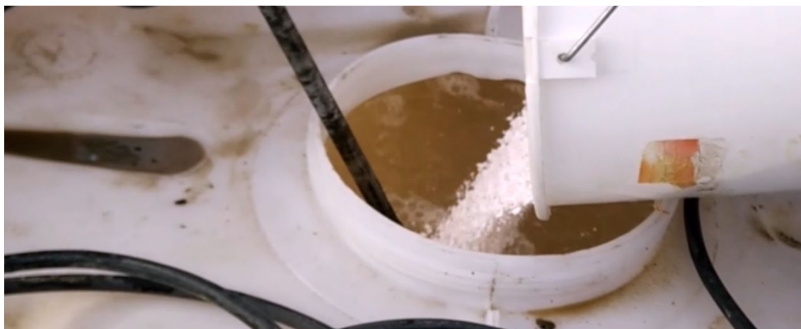
Rys. 5.4 Przygotowanie próbek roztworów chlorków na przykładzie roztworu \text{NaCl}
