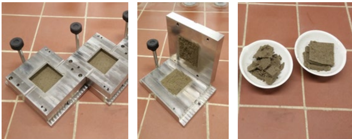
Rys. 6.13 Próbkę wyjęte z aparatu bezpośredniego ścinania po pomiarze
