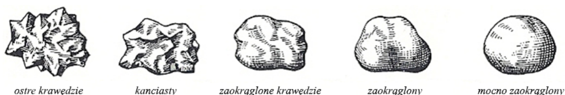
Rys. 3.4 Oznaczenie kształtu (zbliżonych do kulistego) zwartych ziaren [60] (wolny przekład)
