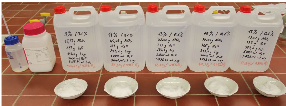
Rys. 6.2 Przykłady przygotowania roztworów z AlCl 3 do badań Proctora
