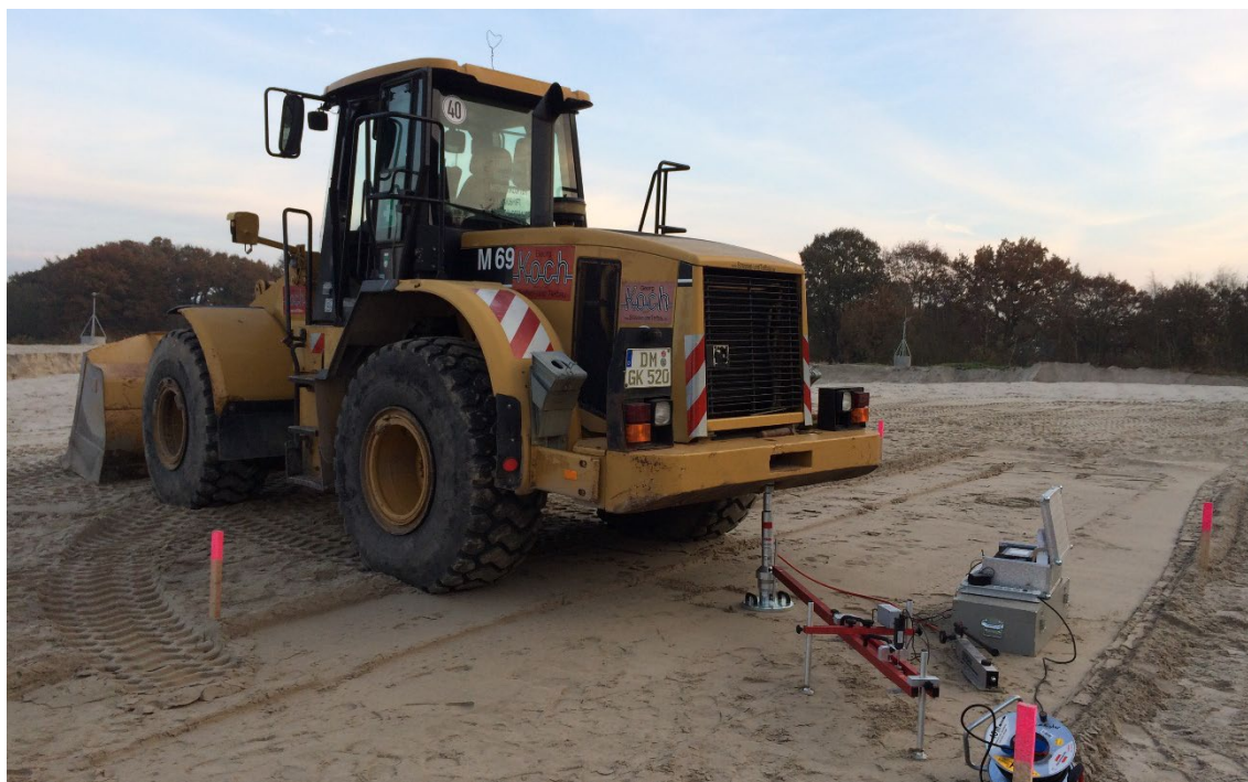
Rys. 5.6 Badanie płytą statyczną w Moorburgu
