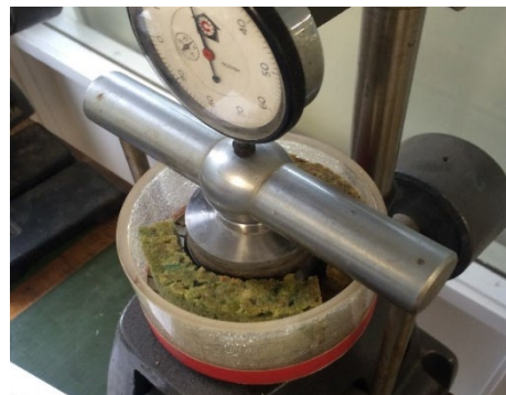
Rys. 6.7 Wilgotne gąbki (np. H 2 O) jako środek zapobiegający wysychaniu badanej próbki
