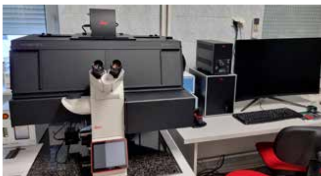
Naukowo-badawczy mikroskop odwrócony LEICA DMi8 z komorą środowiskową.
