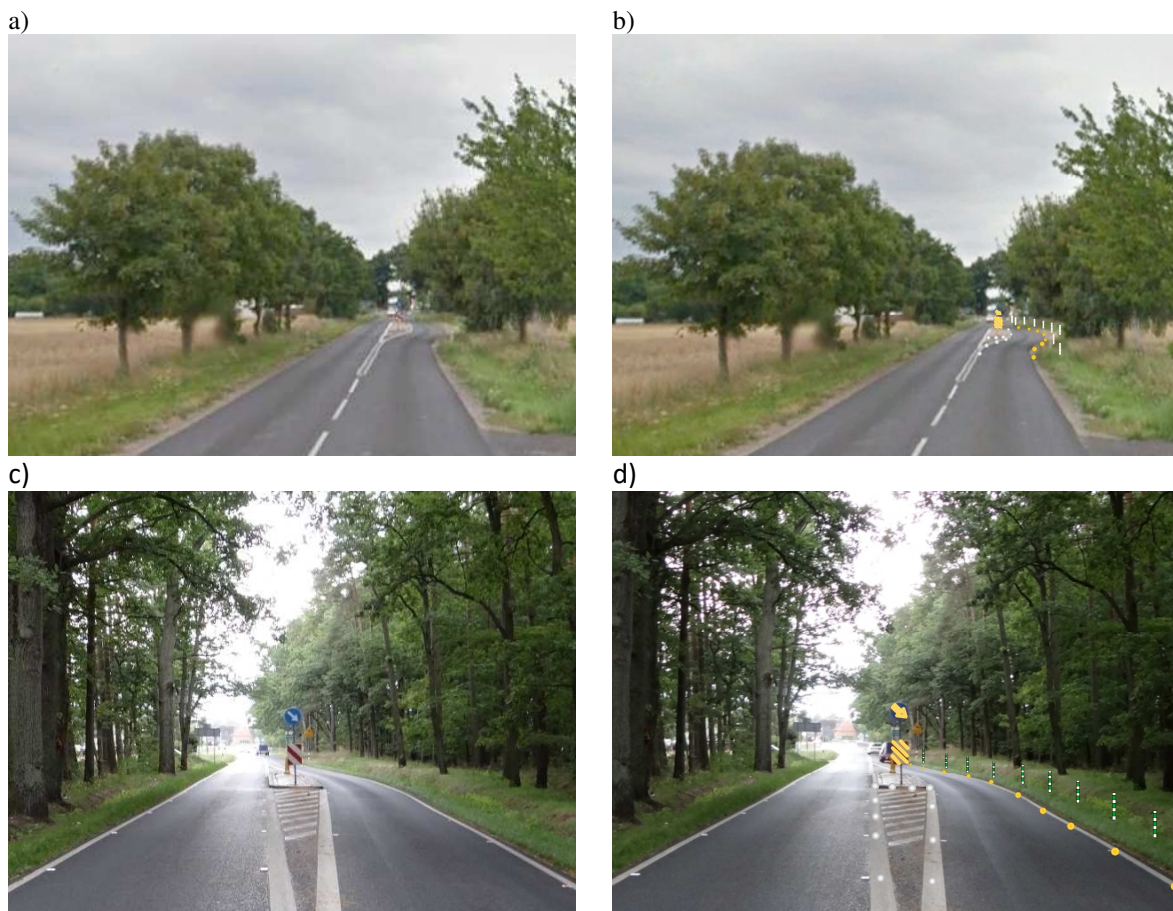
Ryc. 5.26. Wizualizacja wykorzystania najnowszych rozwiązań technologii solarnej wspomaganymi słupkami drogowymi: a) stan istniejący w terenie rolniczym bez widoku sylwety wsi, b) wspomaganie diodami elektroluminescencyjnymi informacji o przeszkodzie w terenie rolniczym, c) stan istniejący w terenie leśnym, d) wspomaganie diodami elektroluminescencyjnymi informacji o przeszkodzie w terenie leśnym
