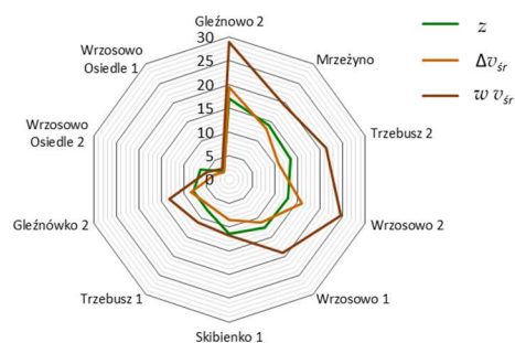
Ryc. 6.13. Zgodność wskaźnika zmian prędkości \Delta v_{sr} , w v_{sr} oraz zagregowanego parametru z (odpowiednio R = 0,92 i R = 0,93 )
