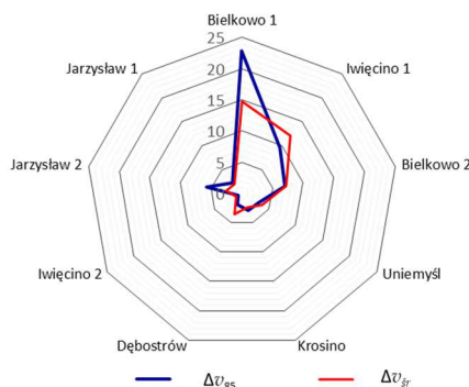
Ryc. 5.11. Porównanie zmian wielkości redukcji prędkości \Delta v_{85} i \Delta v_{sr} oraz sumy miar kwantyfikacyjnych z_d na odcinkach z poligonu badawczego 1
