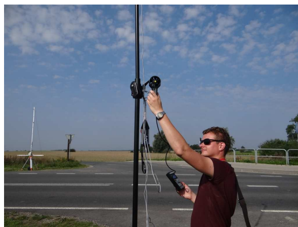
Ryc. 3.53. Odczyt pomiaru prędkości wiatru i odczyt poziomego hałasu ze SVANTKA
