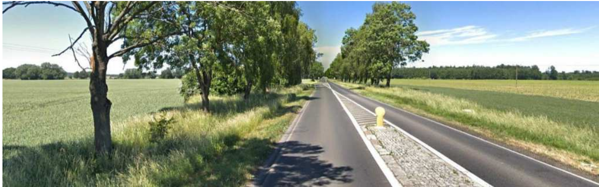
Ryc. 9.6. Brak widoku sylwetki wsi, zabudowań i jakichkolwiek elementów informujących kierowców o konieczności redukcji prędkości (odcinek Brodniki 2)
