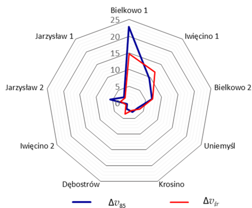
Ryc. 5.17. Porównanie zmian wielkości redukcji prędkości \Delta v_{85} i \Delta v_{sr} oraz sumy miar kwantyfikacyjnych Z_{zw} na odcinkach z poligonu badawczego 1
