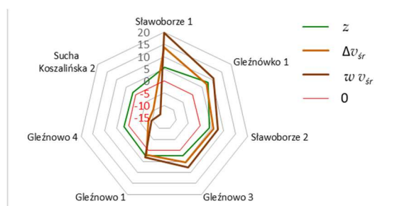
Ryc. 7.10. Zgodność wskaźnika zmian prędkości \Delta v_{sr} , w v_{sr} oraz zagregowanego parametru z (odpowiednio R = 0,70 i R = 0,72 )
