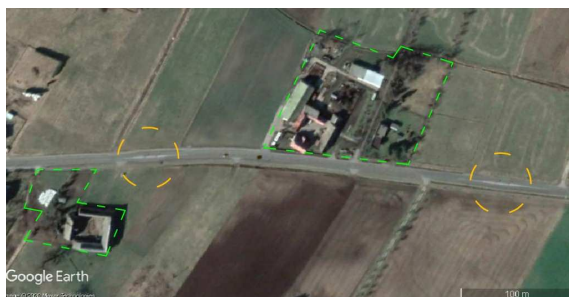
Ryc. 4.4. Przykłady lokalizacji szykan (pomarańczowe koła), zagospodarowania terenu wokół drogi oraz pojedynczej rozproszonej zabudowy otoczonej zagajnikami zieleni (zielony wielokąt), na tle zdjęć satelitarnych przykładowych wsi z programu Google Earth [118]
