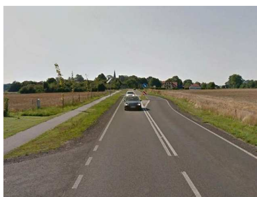
Ryc. 5.6. Przypadek bardzo oddalonej sylwetki wsi za znakiem E-17 i D-42 stojącym 100 m za szykaną
