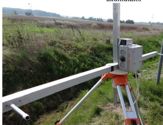
Czujniki pomiarowe do mierzenia prędkości z nasadkami ochronnymi: A i B, w rozstawie 2 m
