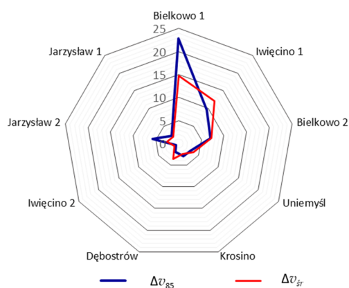
Ryc. 5.9. Porównanie zmian wielkości redukcji prędkości \Delta v_{85} i \Delta v_{sr} oraz sumy miar kwantyfikacyjnych z_o na odcinkach z poligonu badawczego 1
