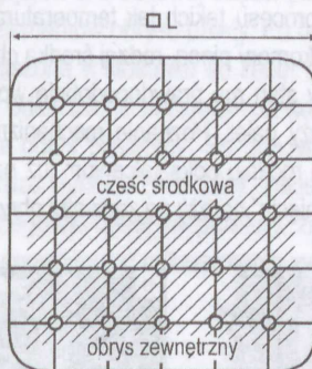
Rys. 50. Umowny podział palety na część środkową, obciążoną wsadem oraz obrys zewnętrzny [37]
