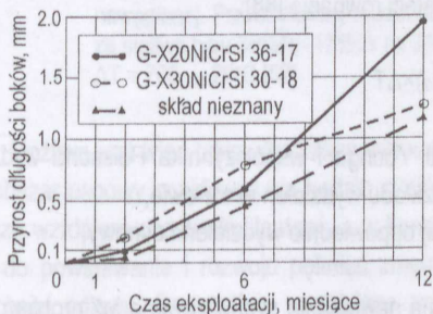
Rys. 28. Przyrost wymiarów liniowych palet (wym. 558x558x36 mm) eksploatowanych w procesie węglazotowania [79]
