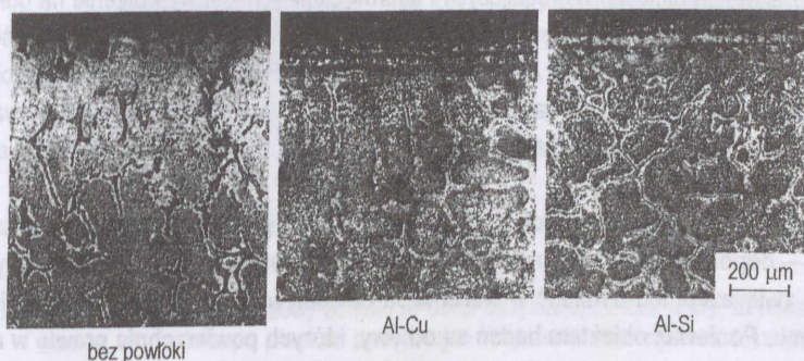
Rys. 97. Porównanie mikrostruktury nawęglonych próbek bez powłoki i zabezpieczonych powłokami po 500 godzinach badań
