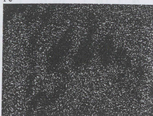
Rys.40 Rozkłady powierzchniowe pierwiastków w stopie 6 w stanie wyżarzonym
