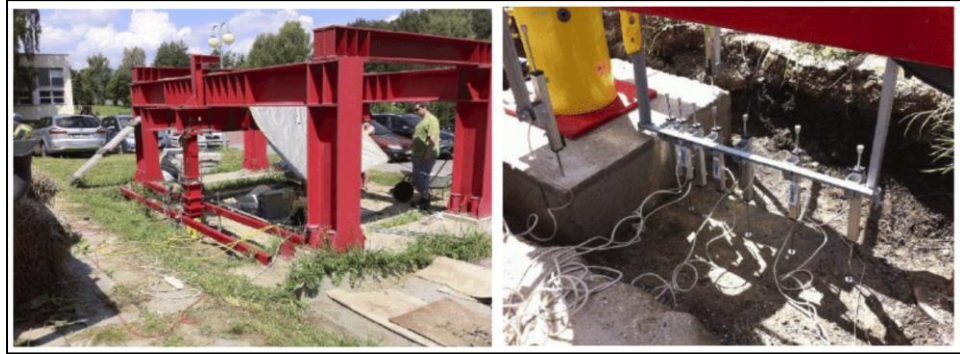
Rys. 3.1. Stanowisko badawcze oraz głowica fundamentu wraz z oprzyrządowaniem (źródło [3])
