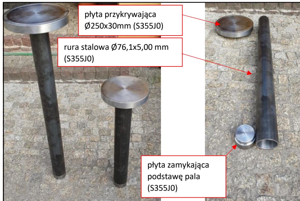
Rys. 6.7. Surowy model pojedynczego fundamentu płytowo-palowego
