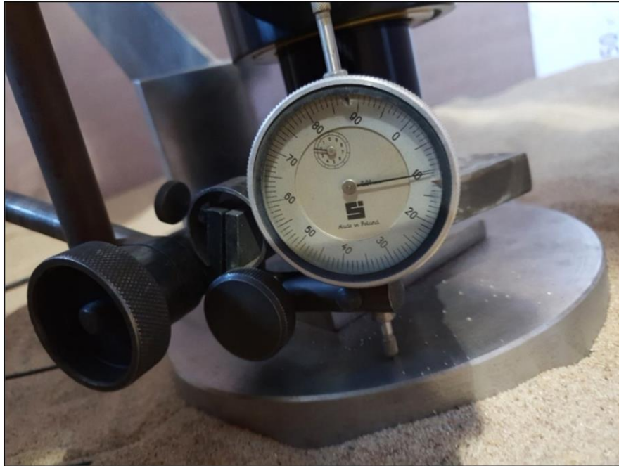
Rys. 6.17. Mikrometr użyty do pomiaru pionowego przemieszczenia pala
