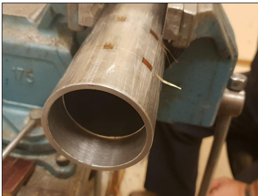
Rys. 6.10. Rura \varnothing 76,3 \times 5 ; L=700 mm - naklewanie tensometrów
