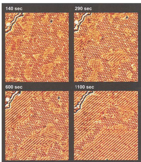
Rys. 6. Utlenianie tlenku węgla na powierzchni Pt(111) pokrytej atomowym tlenem, a następnie poddanej ekspozycji na tlenek węgla ( 5 \cdot 10^{-8} mbar); zdjęcia STM przedstawiają stan powierzchni w różnych czasach od zapoczątkowania reakcji (temperatura 247 K, rozmiar zdjęcia 18 \times 17 nm), w miarę upływu czasu pojawiają się obszary (ukośne linie) odpowiadające wyspom zaadsorbowanego tlenku węgla [56]
