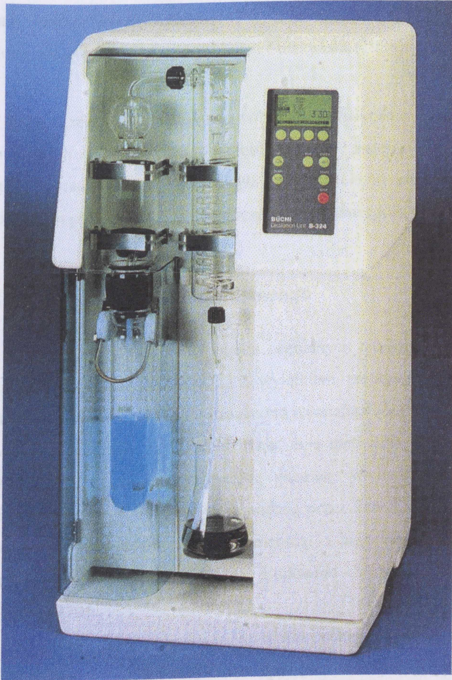
Fotografia 1. Destylarka UNIT B-324 do oznaczania azotu metodą Kjeldahla.
