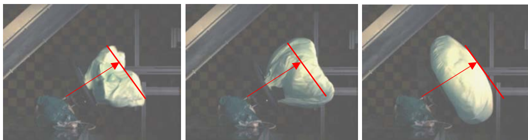
Rysunek 96. Przebieg inflacji poduszki gazowej kierowcy ze wskazaniem zewnętrznego obrysu czoła airbagu [105]
