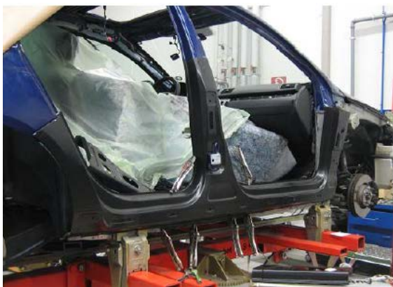
Rysunek 4. a) Zdjęcie wykonane podczas naprawy pojazdu po pierwszym crashteście. b) Zdjęcie naprawionego pojazdu gotowego do przeprowadzenia drugiego testu zderzeniowego wg 96/27/EG, ECE-R95 NCap [6]
