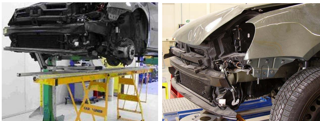
Rysunek 2.z. a) Widok pojazdu po demontażu osprzętu zewnętrznego. b) Zdjęcie uszkodzonych elementów [4]
