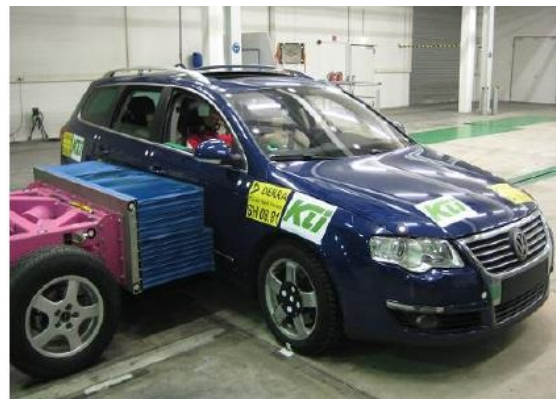
Rysunek 3. a) Schemat próby testu zderzeniowego. b) Zdjęcie z przeprowadzonej pierwszej próby crashtestu wg 96/27/EG, ECE-R95 NCap [6]
