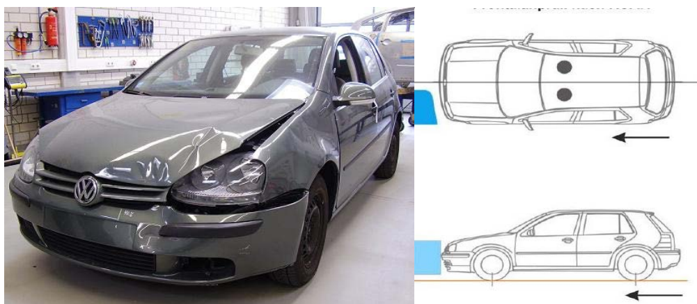
Rysunek 1.z. a) Widok ogólny uszkodzonego pojazdu. b) Schemat przebiegu crashtestu [4]
