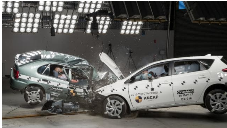
Rysunek 9. Test zderzeniowy Toyota Corolla 1998 i Toyota Corolla 2015 przeprowadzony podczas Światowego Tygodnia Bezpieczeństwa Ruchu Drogowego Organizacji Narodów Zjednoczonych w 2017 r. [31]
