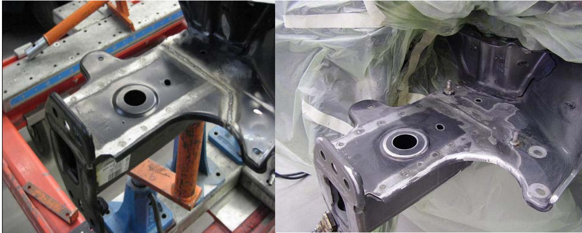
Rysunek 9.z. Widok po naprawie; a) W stanie surowym. b) Po usunięciu lica spoiny za pomocą szlifowania [4]
