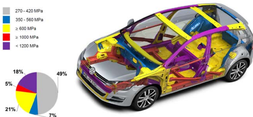
Rysunek 11. Zastosowanie różnej pod względem wytrzymałości stali DP w budowie nadwozia samonośnego pojazdu na przykładzie Volkswagen Golf [32]
