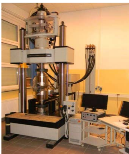
Rysunek 41. Stanowisko badawcze do quasi-statycznego zrywania próbek
