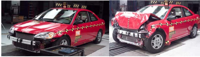
Rysunek 71. Zdjęcia poglądowe pojazdu Honda Civic a) przed i b) po czołowym uderzeniu w nieodkształcalną przeszkodę [24]
