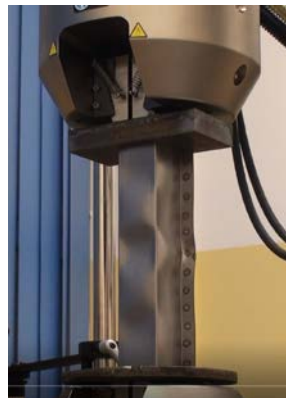
Rysunek 62. Charakterystyczne półfale (wyboczenia lokalne) pojawiające się na ściankach ściskanego modelu klasy 4.
