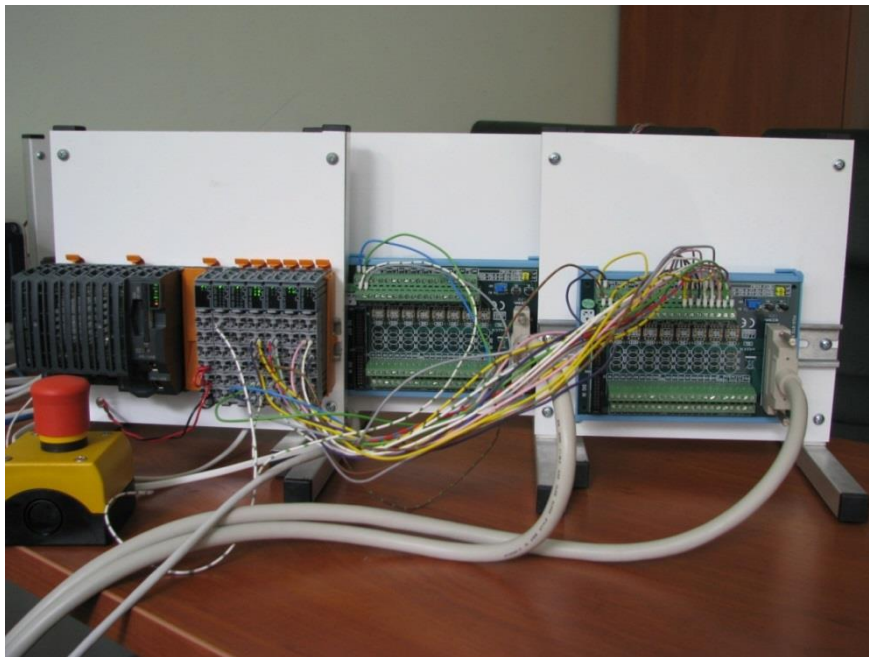
Rys. 5.6. Stanowisko do symulacji HiL sterownik B&R CP1585 i karty Advantech PCI-1710HGU-DE
