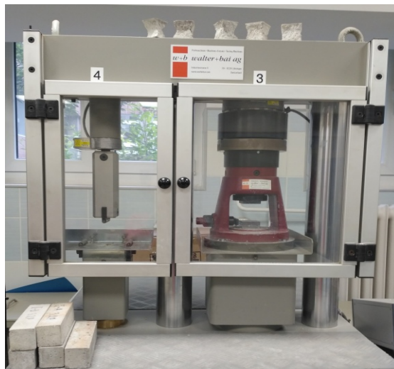
Rysunek 9.4. Dwumodułowa maszyna wytrzymałościowa do pomiarów wytrzymałości na zginanie i ściskanie (Walter + Bai, typ OB 3000/200)
