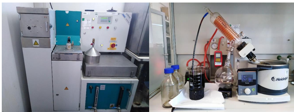
Rys. 3-2 Ekstraktor i wyparka obrotowa użyta do odzyskania lepiscza asfaltowego
