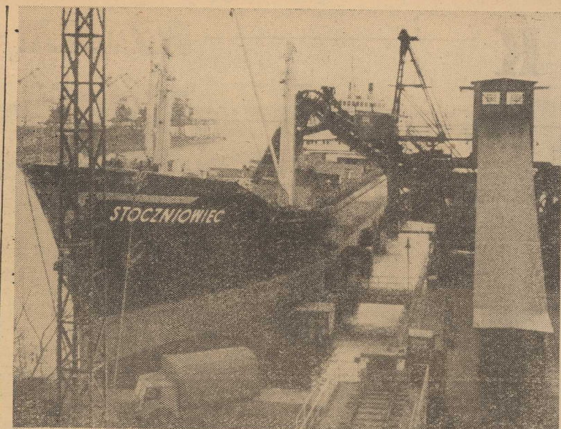
Polska flota dysponuje dotychczas masowcami o nośności 15 tys. DWT. Są to trampy typu „Kolejarz”, z których jeden jest widoczny na zdjęciu. Ostatnio jednak PZM zamówiła w stoczni w Trieście dwa „bulk-carriery” o nośności 23 tys. DWT.
