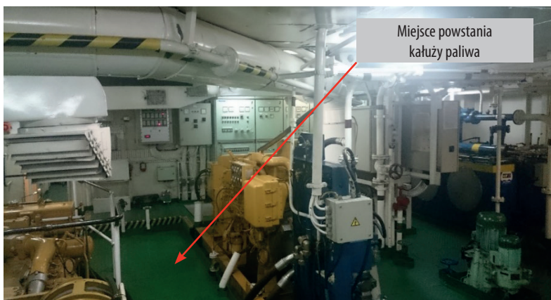
Rys. 5.6. Widok siłowni promu m/s Bielik ze wskazanym miejscem powstania pożaru
