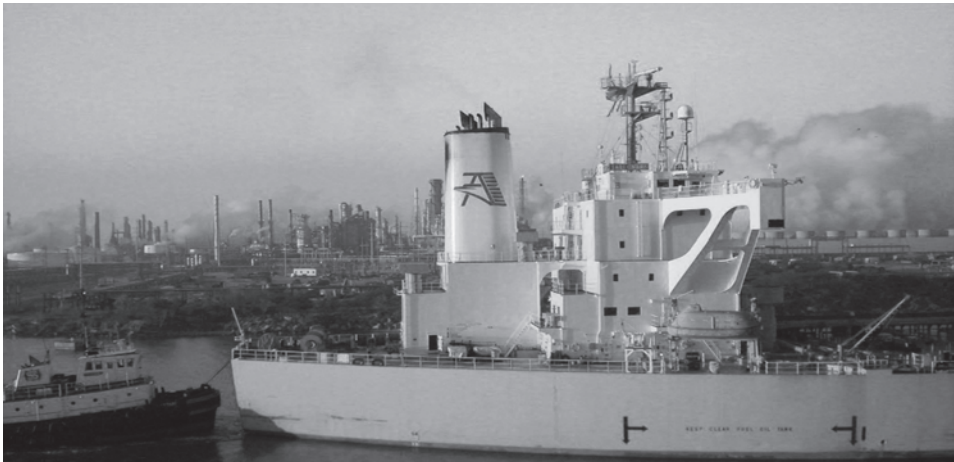
Rys. 1.8. Przykład zastosowania dyslokacji szybu siłowni poprzez wydzielenie go z nadbudówki
