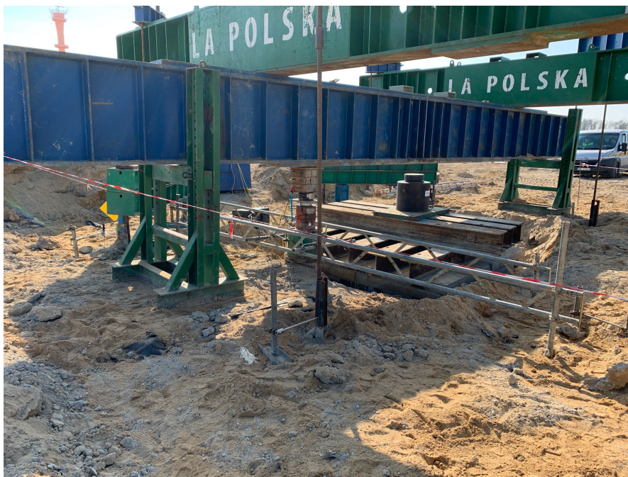
Rys. 38 Trwające badanie pala za pomocą siłownika [opracowanie Autora]
