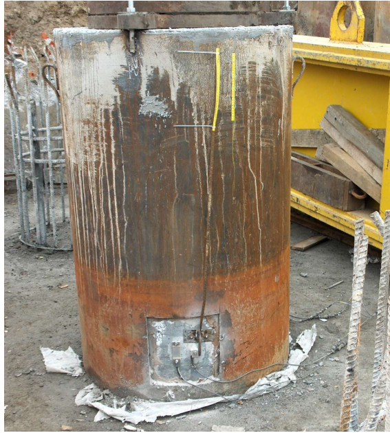
Rys. 20 Głowica przygotowania do badania dynamicznego [84]
