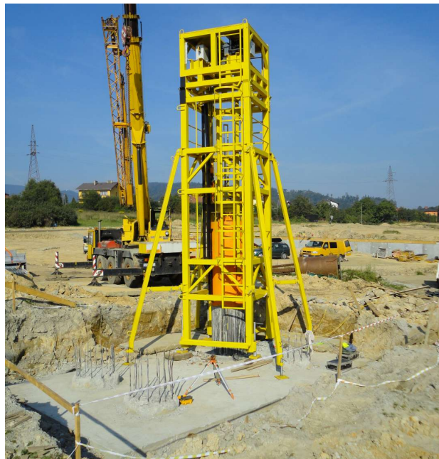
Rys. 19 Stanowisko do badania dynamicznego [84]
