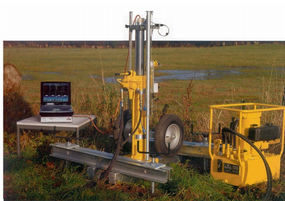
Rys. 30 Lekka sonda do badań CPT [84]
