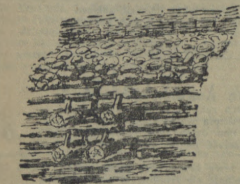
Sposób umocnienia części fundamentowych wału za pomocą tzw. konstrukcji hakowej, typowy dla budownictwa pierwszych Piastów.
