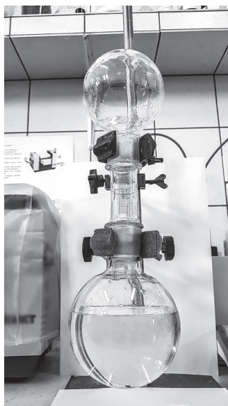
Ryc. 6.34. Stanowisko do oznaczania skutków zanurzenia materiału w ciekłych chemikaliach
