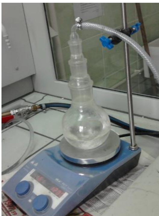
Rys. 30. Stanowisko do suszenia i odgazowywania surowców używanych do syntezy EPUR.
