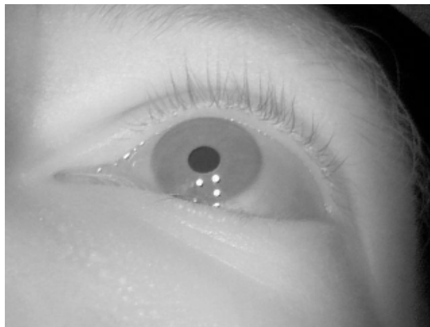
Rysunek 2.8: Przykładowy obraz zarejestrowany przez kamerę skierowaną na oko użytkownika eye trackera DIY . Oko wypełnia dużą część kadru, przez co możliwe jest precyzyjne znalezienie środka źrenicy. Widoczne są trzy odbicia rogówkowe podczerwonych diod doświetlających oko. Przez źrenicę widoczny jest zaciemniony obszar siatkówki, przez co mamy do czynienia ze zjawiskiem dark pupil ułatwiającym odnalezienie źrenicy.
