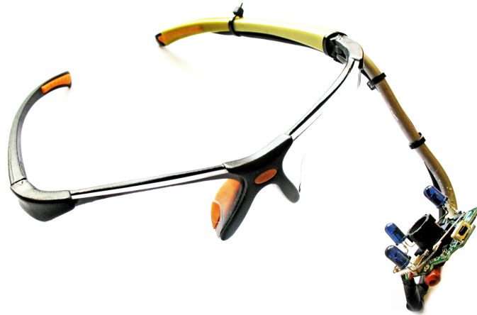
Rysunek 2.6: Urządzenie DIY zostało zbudowane na bazie okularów ochronnych oraz elementów dostępnej na rynku kamery internetowej.
