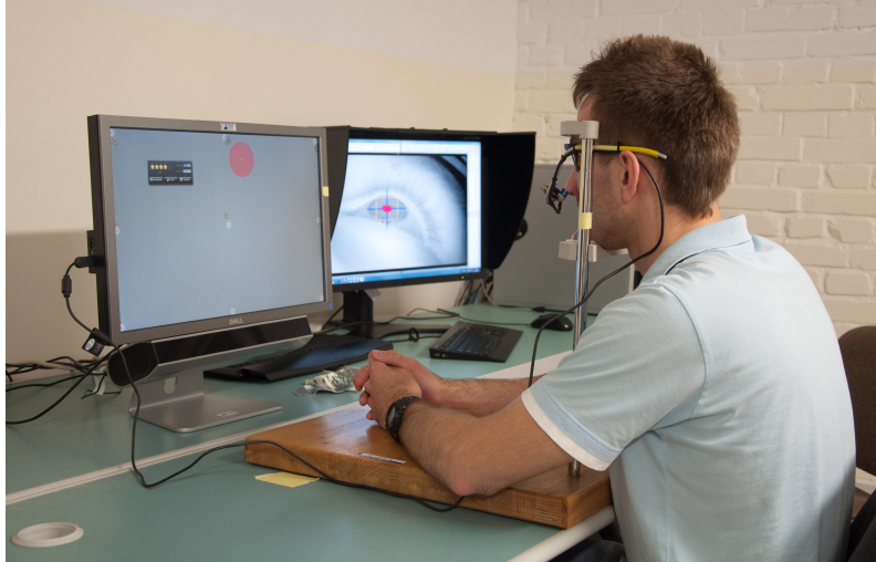
Rysunek 2.5: System DIY podczas pracy. Konieczne jest wykorzystanie podbródka stabilizującego położenie i orientację głowy.
