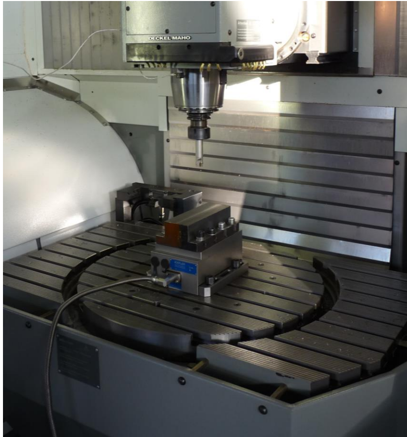
Rysunek 74. Mocowanie próbki na siłomierzu Kistler
