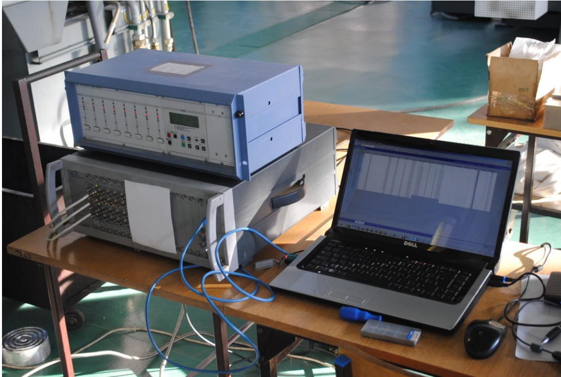
Rysunek 72. Układ akwizycji sygnałów drgań i sił oraz wzmacniacz siłomierza
