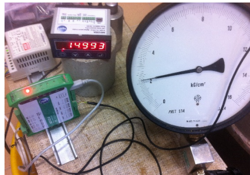
Rys. 23. Wyniki kalibracji oprzyrządowanego pała modelowego
