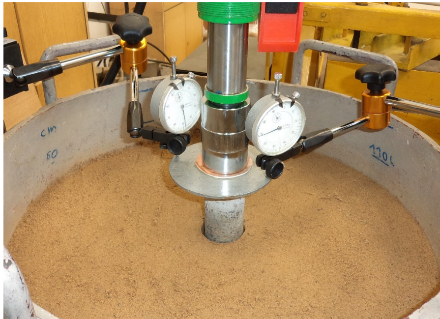
Rys. 30. Próbné obciążenie pala bez oporu pobocznicy. Druga część badań
