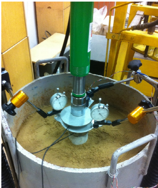
Rys. 24. Przygotowane stanowisko badawcze do próbnych obciążeń statycznych z pomiarem oporu pod podstawą pała. Pierwsza część badań
