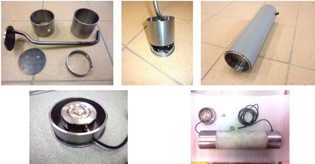
Rys. 21. Elementy składowe oprzyrządowanego pala modelowego [41]
