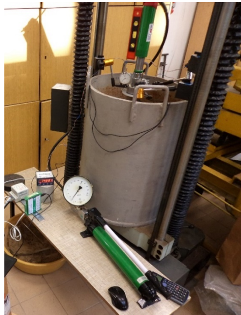
Rys. 24. Przygotowane stanowisko badawcze do próbnych obciążeń statycznych z pomiarem oporu pod podstawą pała. Pierwsza część badań
