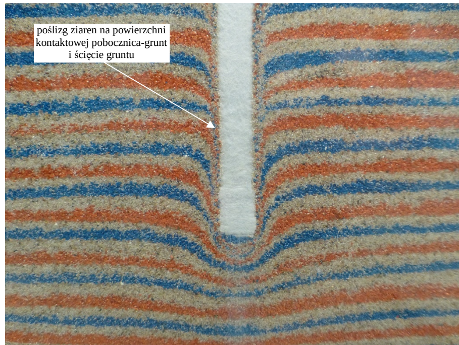
Rys. 35. Ugięcie warstw podłoża gruntowego spowodowane osiadaniem pala
