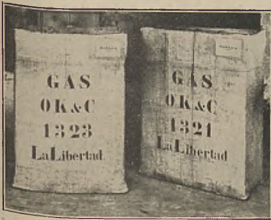
Abb. 3. Wie man heute Parfümerien exportiert: Statt der Kiste ein mehrfach umreifter Holzstoffkarton, der mit Jute verleimt wird.
