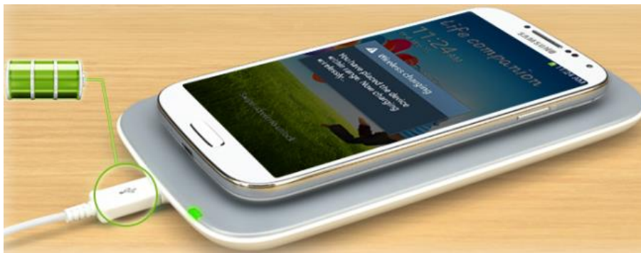
Rys. 1.3 Przykładowa stacja bezstykowego ładowania telefonów komórkowych [5]
