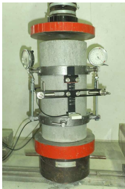
Rys 7.2 Próbka przygotowana do badania modułu sprężystości betonu
