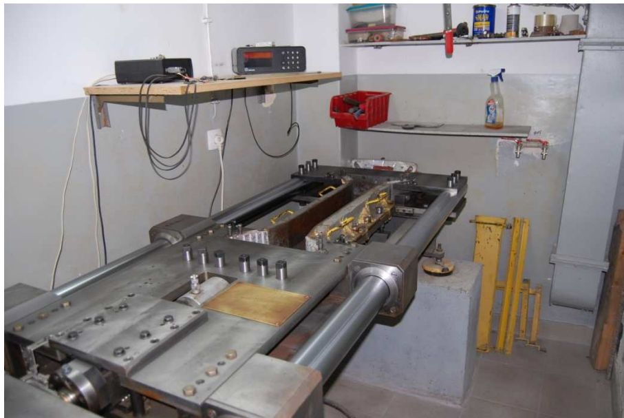
Rys 7.6 Urządzenie do badań reologicznych młodego betonu
