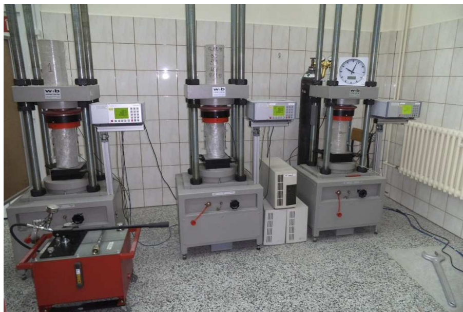
Rys 7.3 Stanowisko do badań pełzania przy ściskaniu
