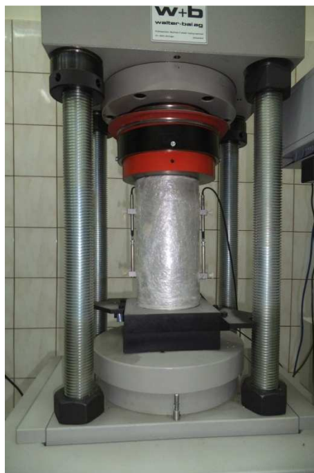
Rys 7.4 Próbka umieszczona w pełzarce i przygotowana do badania pełzania przy ściskaniu
